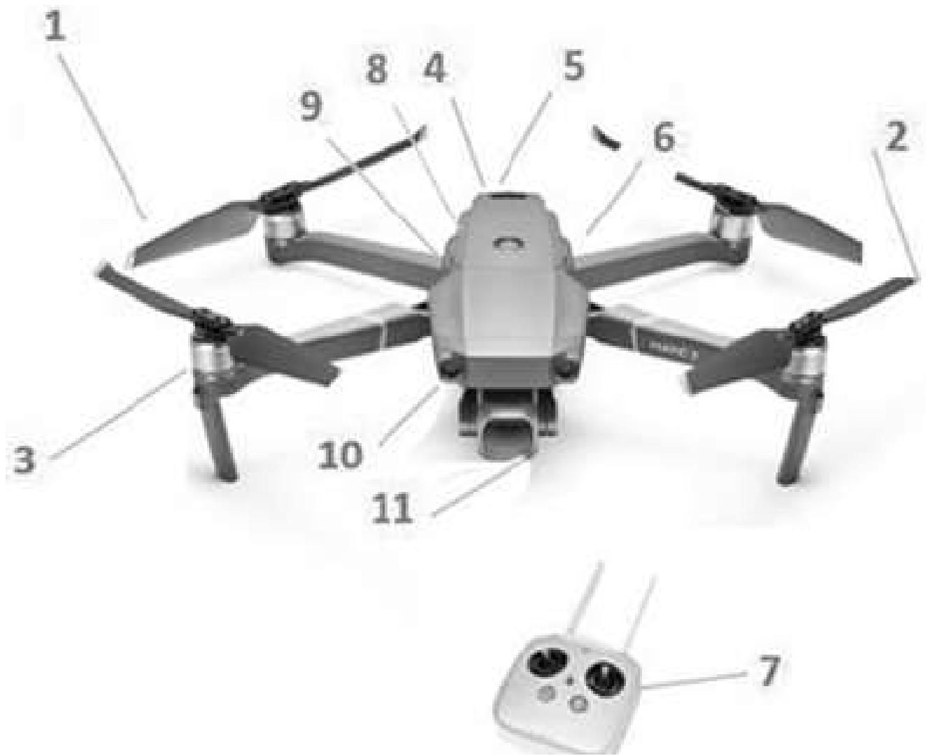
Рис. 2.1. Квадрокоптер DJI Mavic 2 pro:
