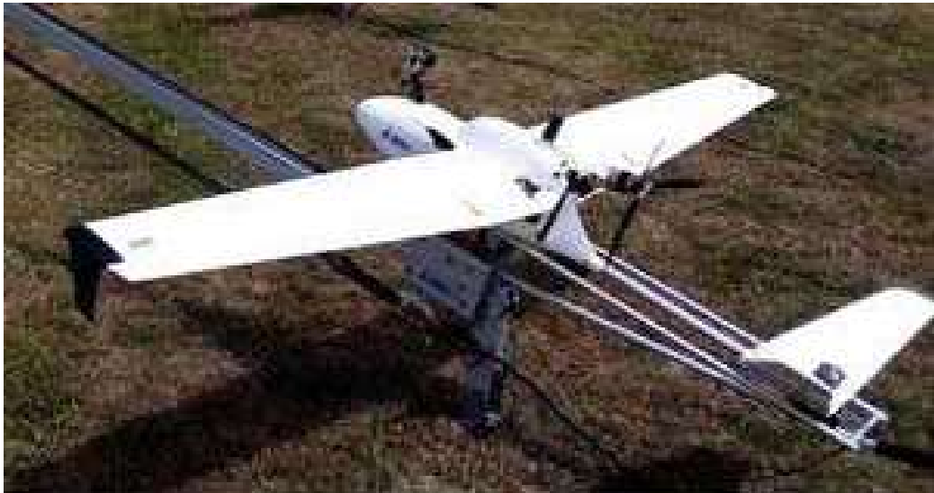
Рис. 1.9. БПЛА літакового типу моделі Cetus (компанії Abris, Україна)
