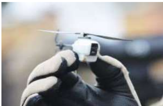
Рис.1.7. Мікро дрон Black Hornet вагою 33 г
