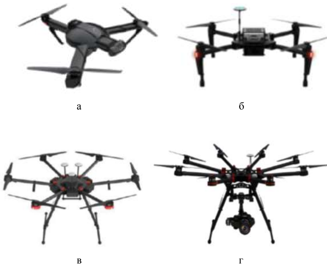
Рис. 1.11. Типи дронів: а) трикоптер; б) квадрокоптер; в) гексакоптер; г) октокоптер;
