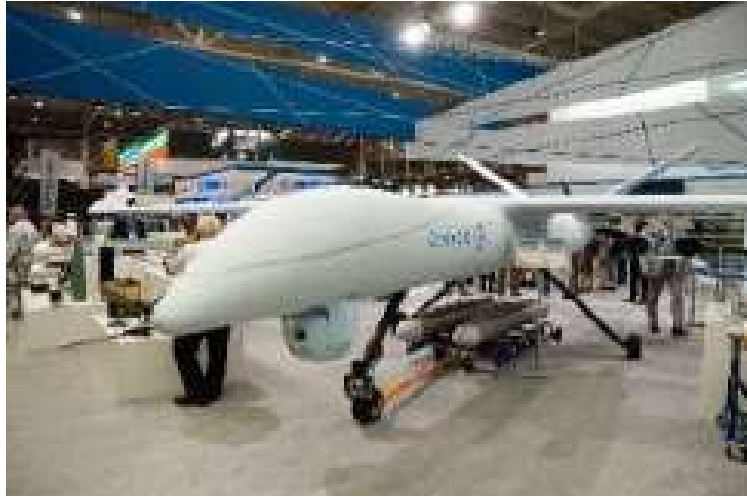
Рис.1.14 БПЛА літакового типу моделі Сокіл-300, (Україна)
