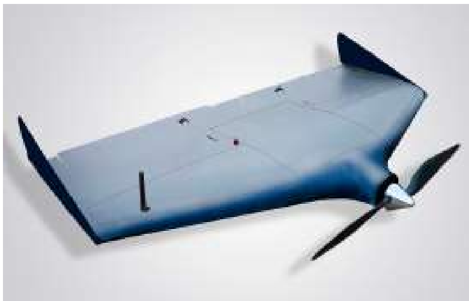
Рис. 1.16. Літаковий БПЛА типу «крило, що літає»
