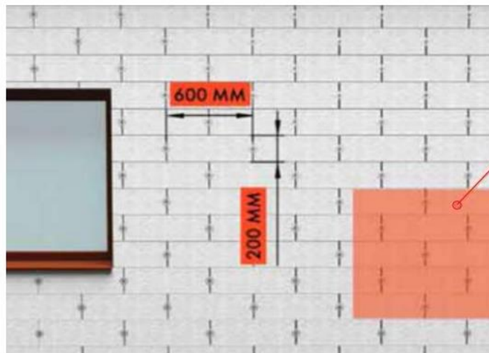
Схема розміщення дюбелів в звичайній зоні: 6 дюбелів на 1 м 2
