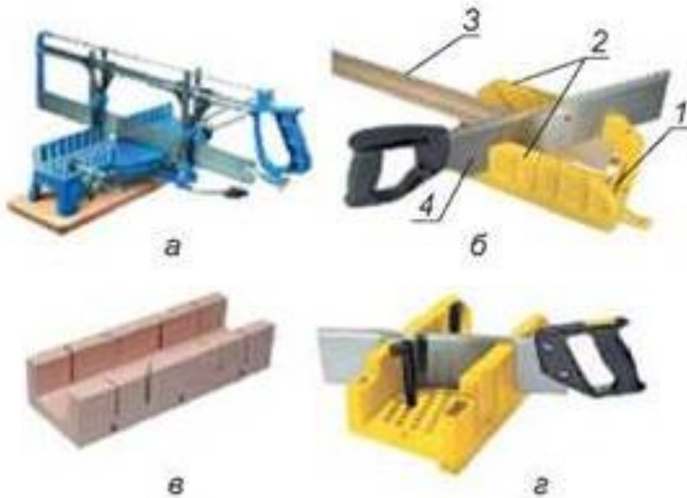
Рис. 1.6. Види стусел: а – стаціонарне поворотне; б – пластикове; в – дерев'яне; г – із затискним пристроєм
