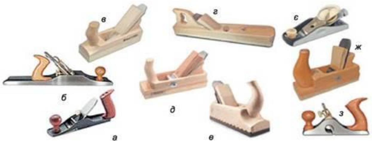
Рис. 1.8. Інструменти для стругання плоских поверхонь: а – шерхебель металевий, б – напівфуганок металевий, в – рубанок з одинарним ножом; г – фуганок; д – подвійний рубанок, е – шліфтик, є – торцевий рубанок; ж – цинубель; з – рубанок циклювальний
