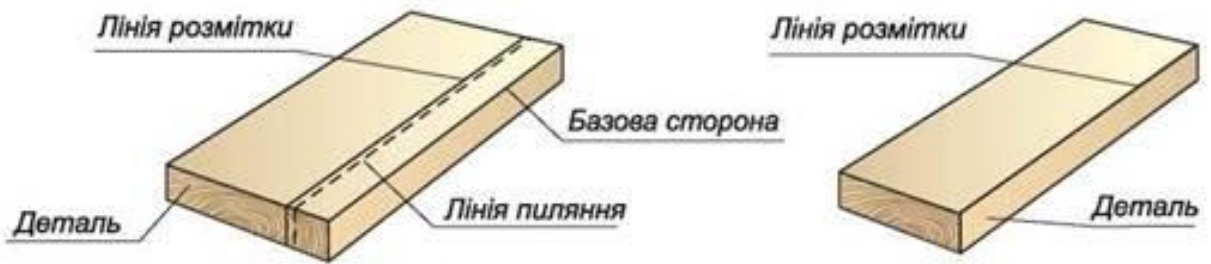
Мал. 68. Розпилювання заготовки
