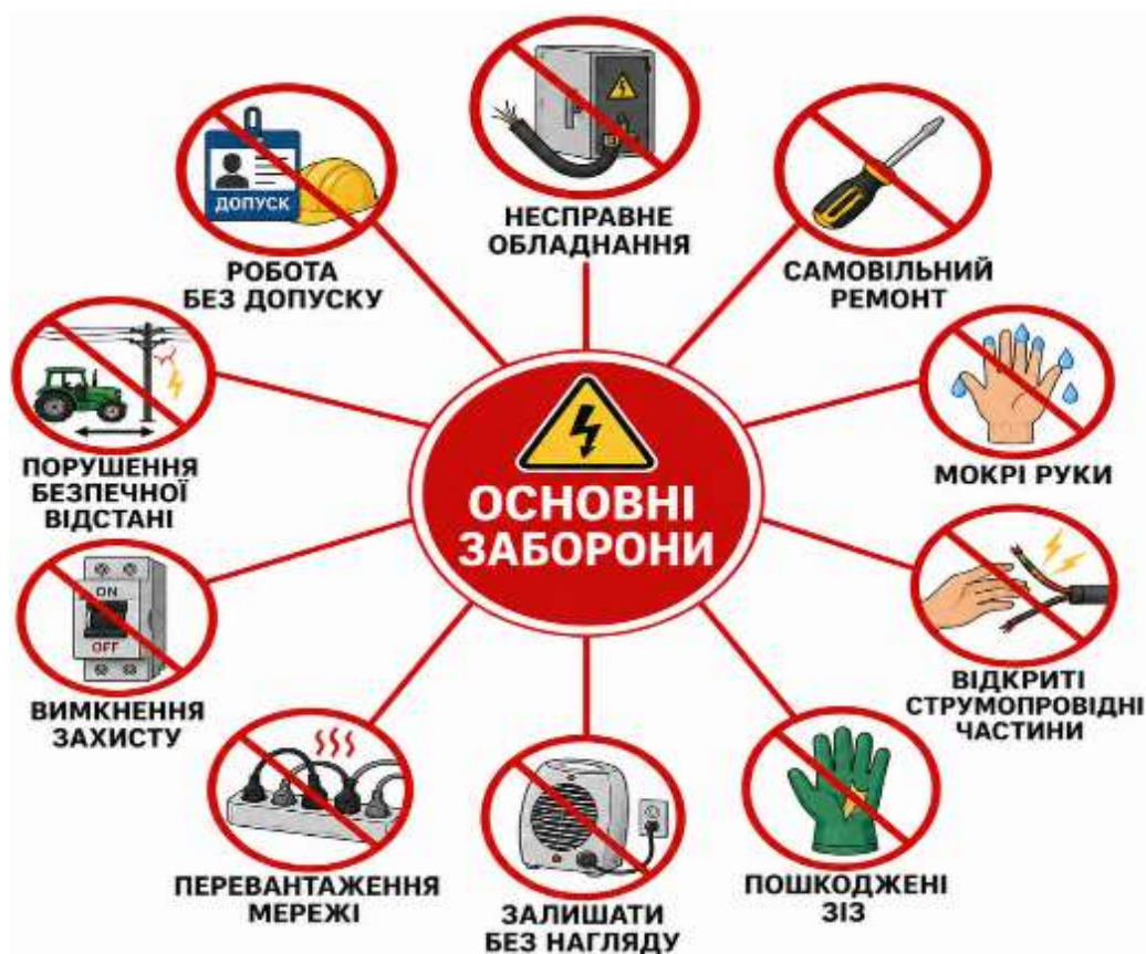
Рис. 12.3. Основні заборони під час виконання робіт в електроустановках
