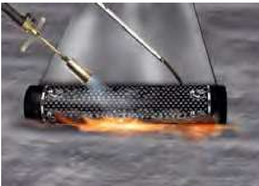
Рис. 2.1 - Суцільне наплавлення матеріалу на основу
