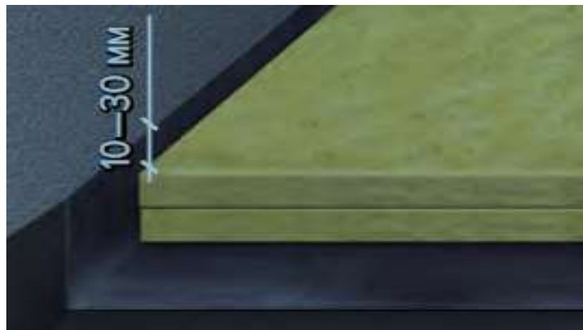
Рис.2.3 - Правила укладання пароізоляції з рулонних матеріалів
