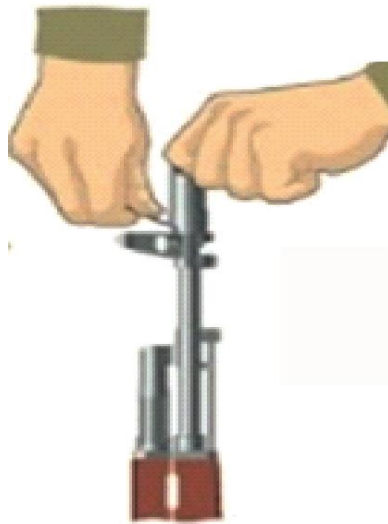
Рисунок 6 – від'єднання гальма-компенсатора (полум'ягасник у РПК).
