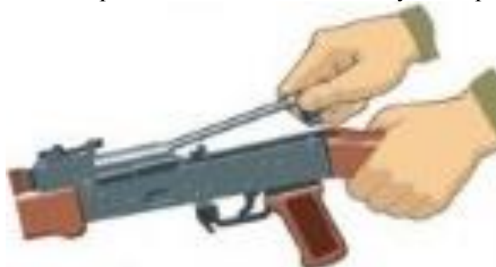
Рисунок 8 – від'єднання поворотного механізму.
