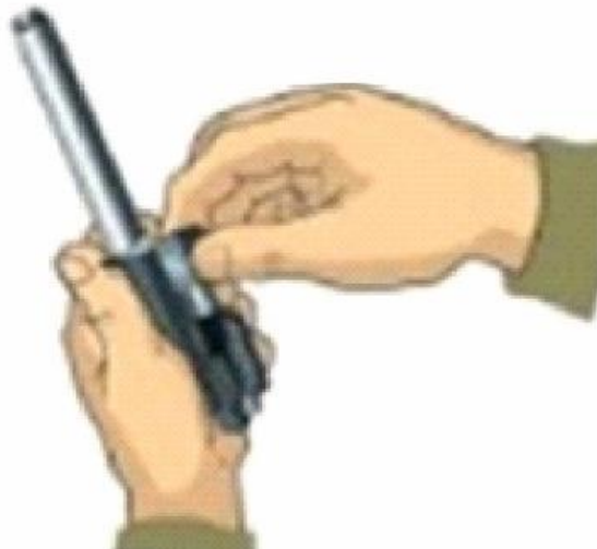
Рисунок 10 – від'єднання затвору від затворної рами.
