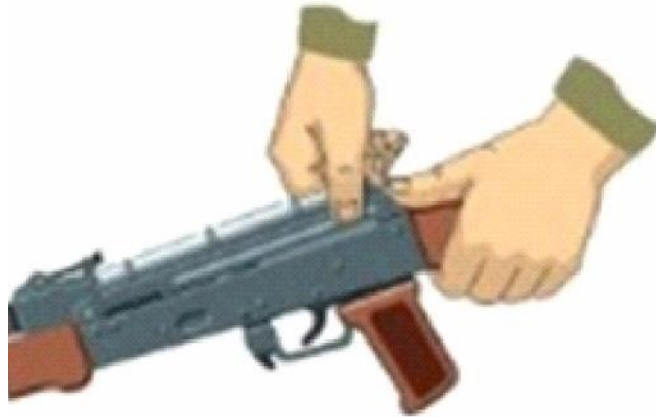
Рисунок 7 – від'єднання кришки ствольної коробки.
