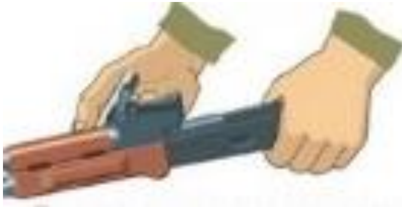
Рисунок 11 – від'єднати газову трубку із ствольною накладкою.
