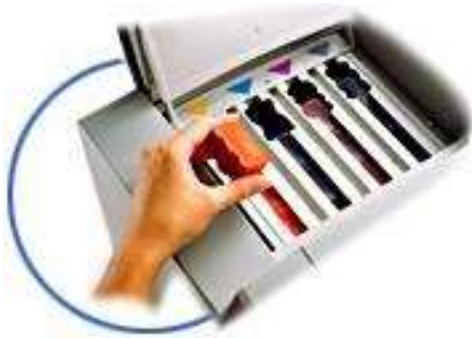
Рис. 54 Заправка фарби в твердофарбовий принтер
