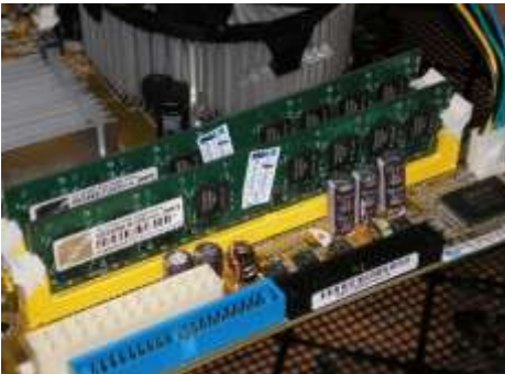
Рис. 21. Розміщення ОЗП на материнській платі
