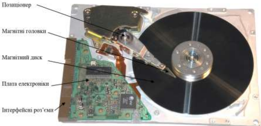
Рис. 39. Внутрішня будова накопичувача на жорстких магнітних дисках
