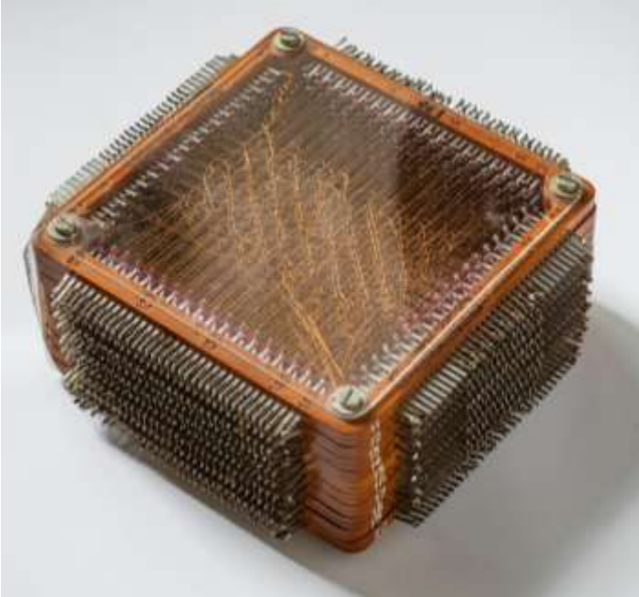
Рис. 7. Магнітна пам'ять на феритових осердях
