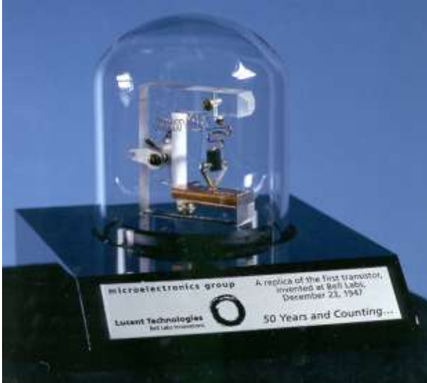
Рис. 5. Репліка першого транзистора, винайденого в Bell Labs [3]
