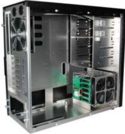
Рис.81. Корпус типу «вежа» ( tower )
