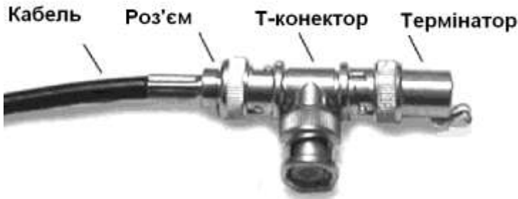
Рис. 65. Роз'єми коаксіального кабеля
