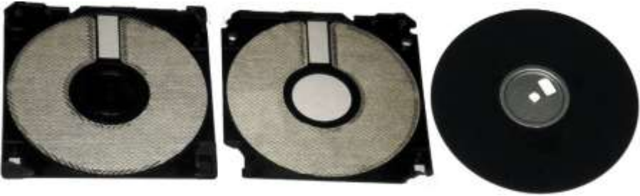
Рис. 42. Дискета 3,5'' у розібраному вигляді
