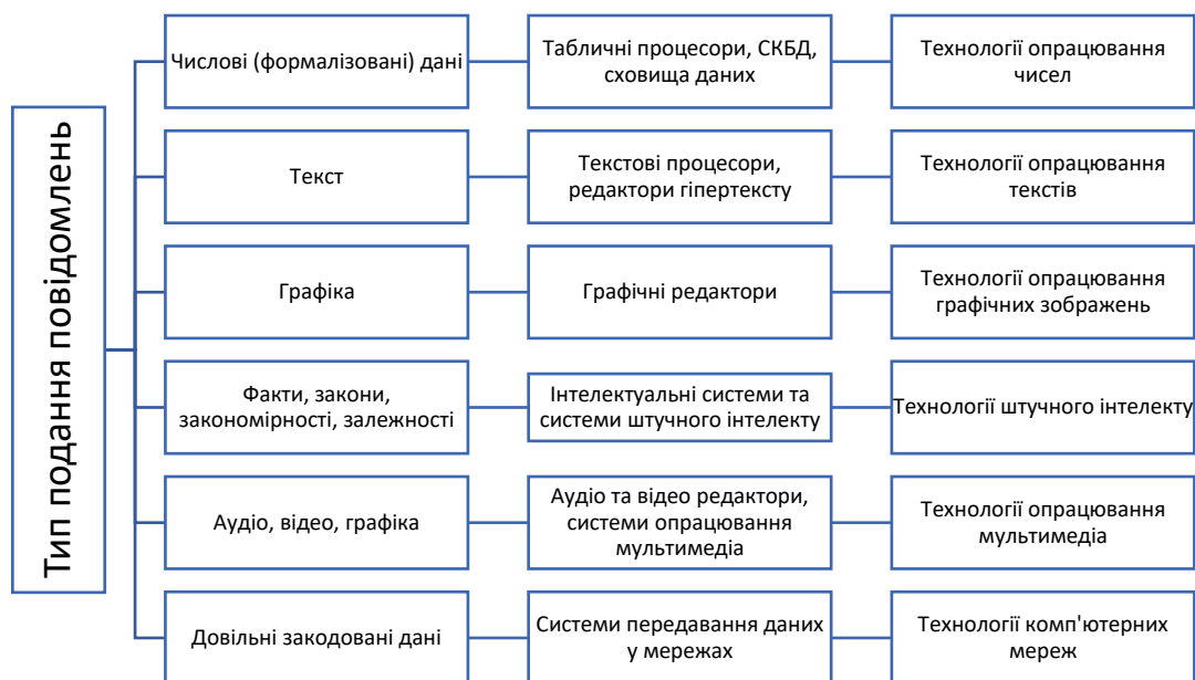
Рис. 1.3 Схема класифікації ІКТ за типом повідомлень, що опрацьовуються
