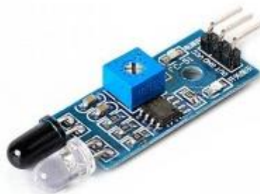
Рис. 2.20 - FC-51 інфрачервоний датчик перешкод для ARDUINO
