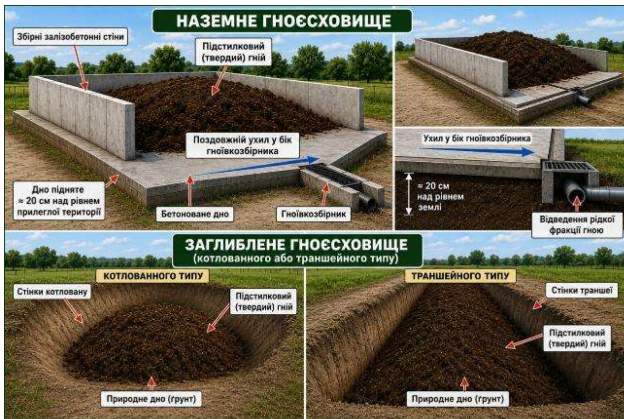
Рис. 6.20. Наземне та заглиблене гноєсховища для зберігання твердого (підстилкового) гною
