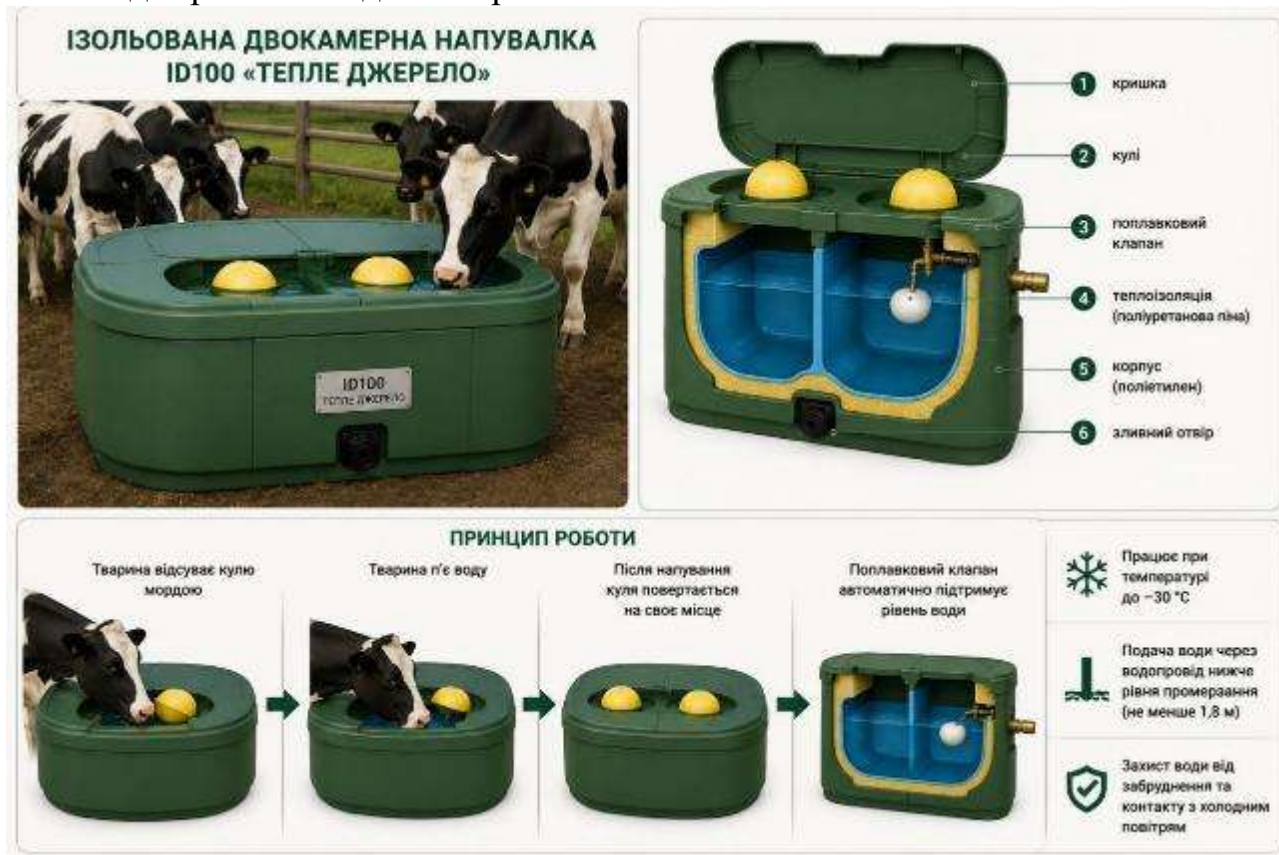
Рис. 3.18. Ізольована двокамерна автонапувалка ID100 «Тепле джерело»: загальний вигляд, будова та принцип роботи
