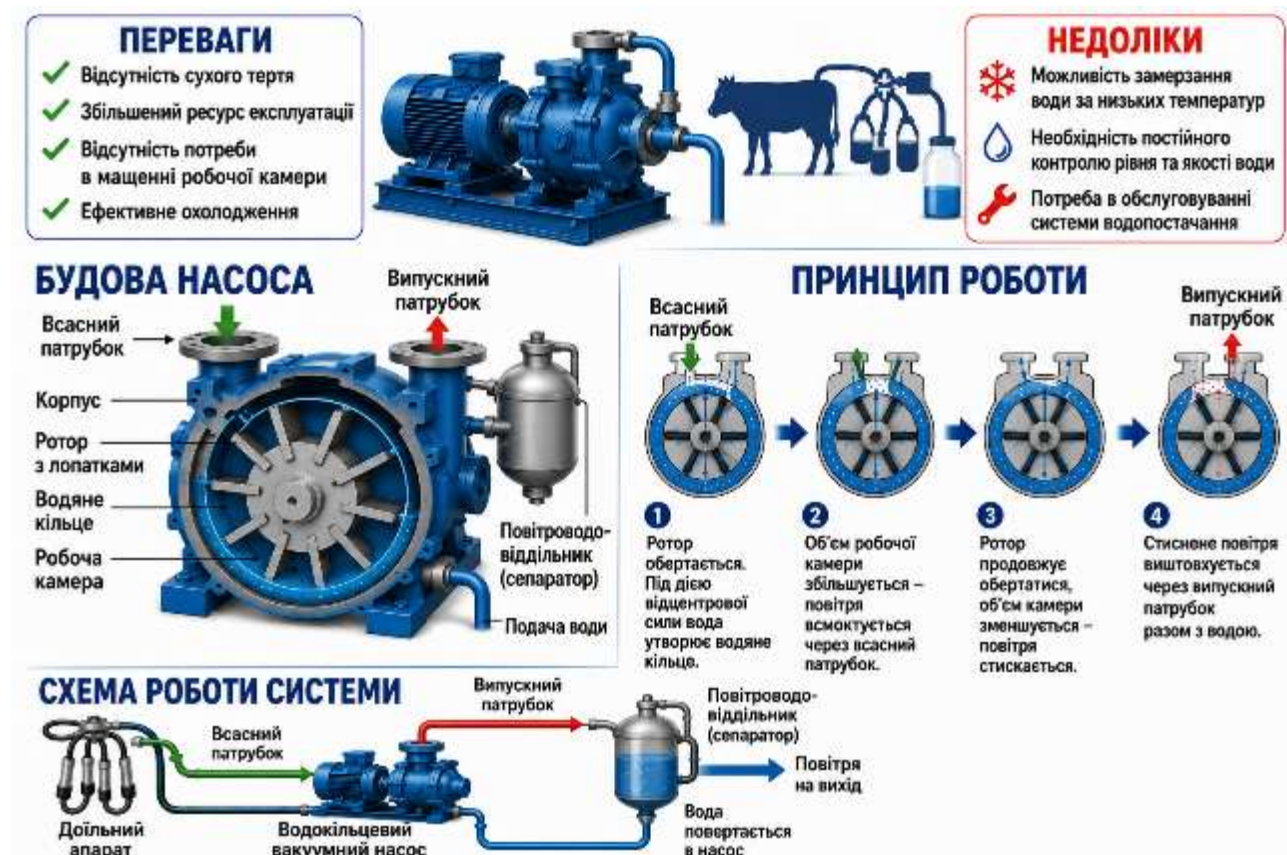
Рис. 7.11. Будова та принцип роботи водокільцевого вакуумного насоса
