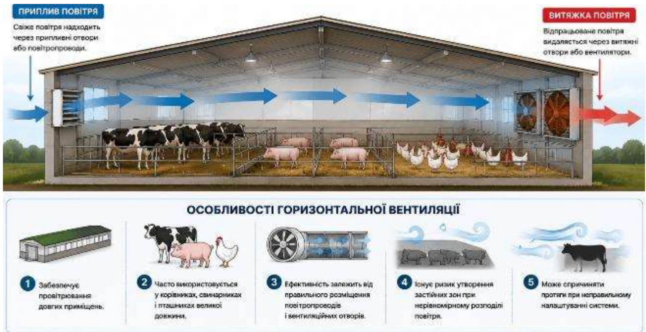
Рис. 2.19. Принцип дії та особливості горизонтальної вентиляції
