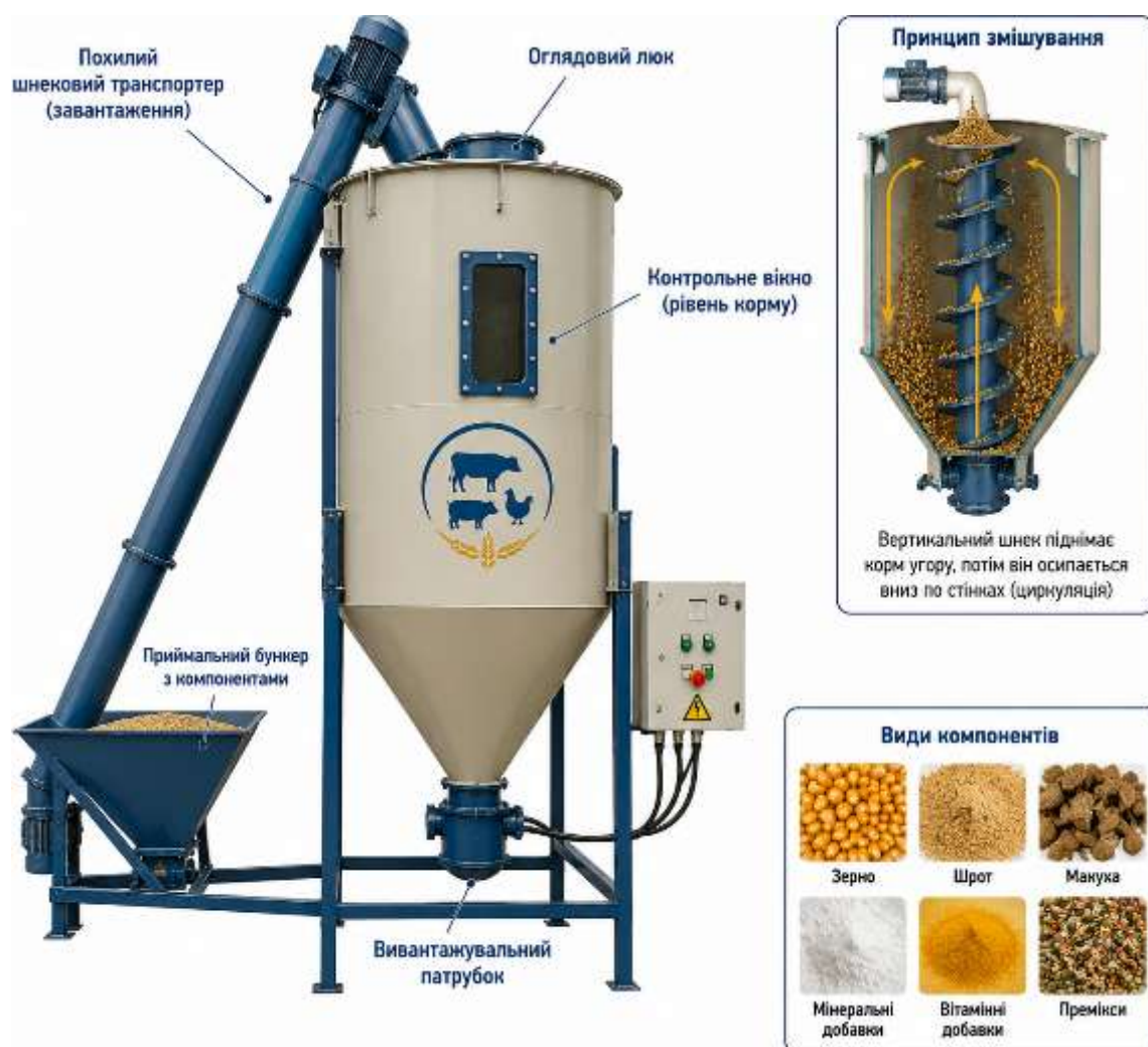
Рис. 4.23. Загальний вигляд, основні конструктивні елементи та принцип роботи вертикального шнекового змішувача комбікормів
