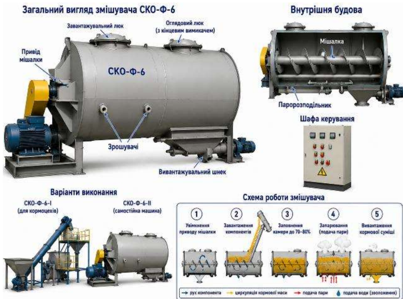
Рис. 4.24. Загальний вигляд, будова та технологічний процес роботи змішувача кормів СКО-Φ-6 (СКО-Φ-3)
