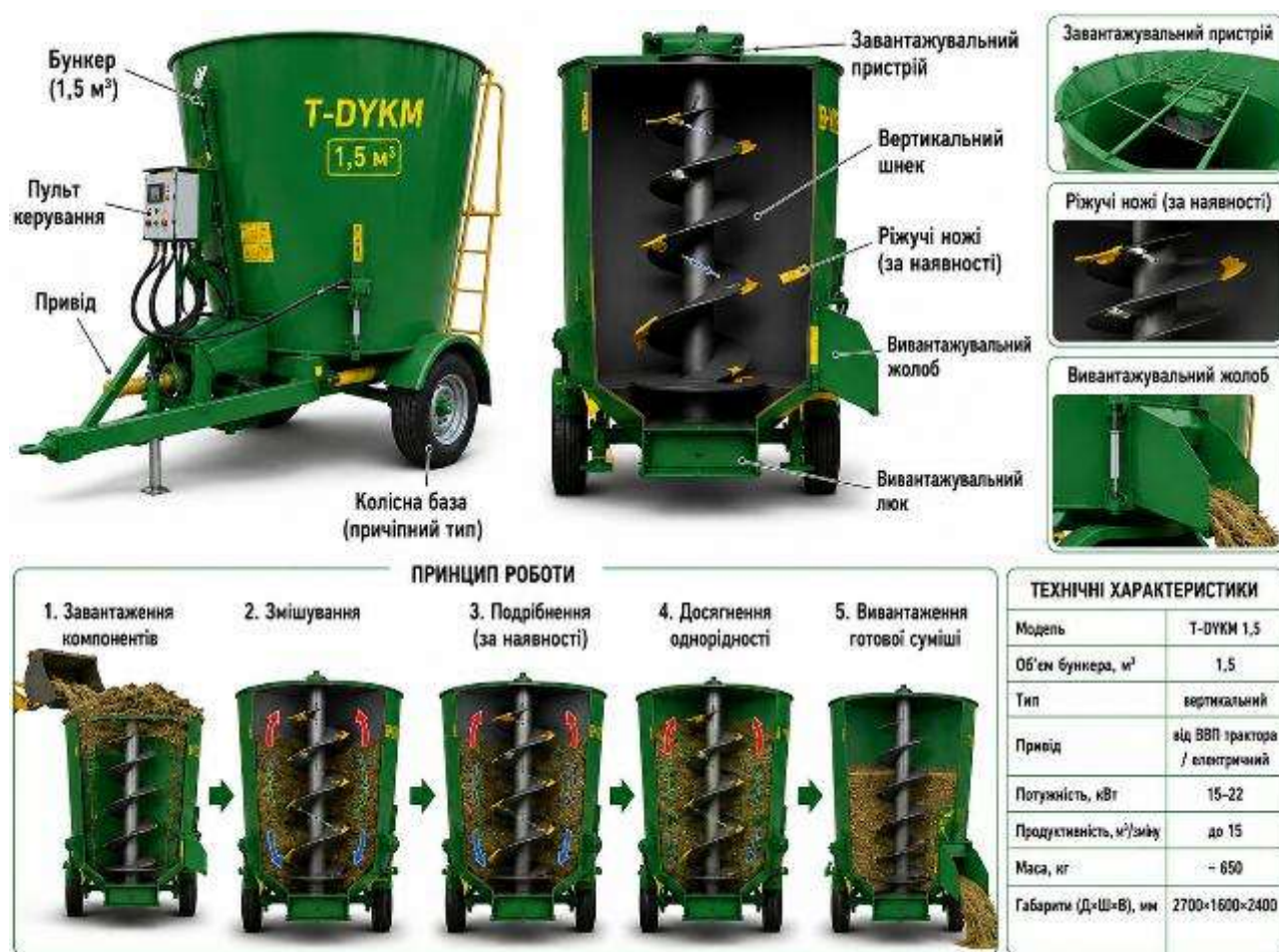
Рис. 4.26. Загальний вигляд, будова та технологічний процес роботи змішувача серії T-DYKM 1,5
