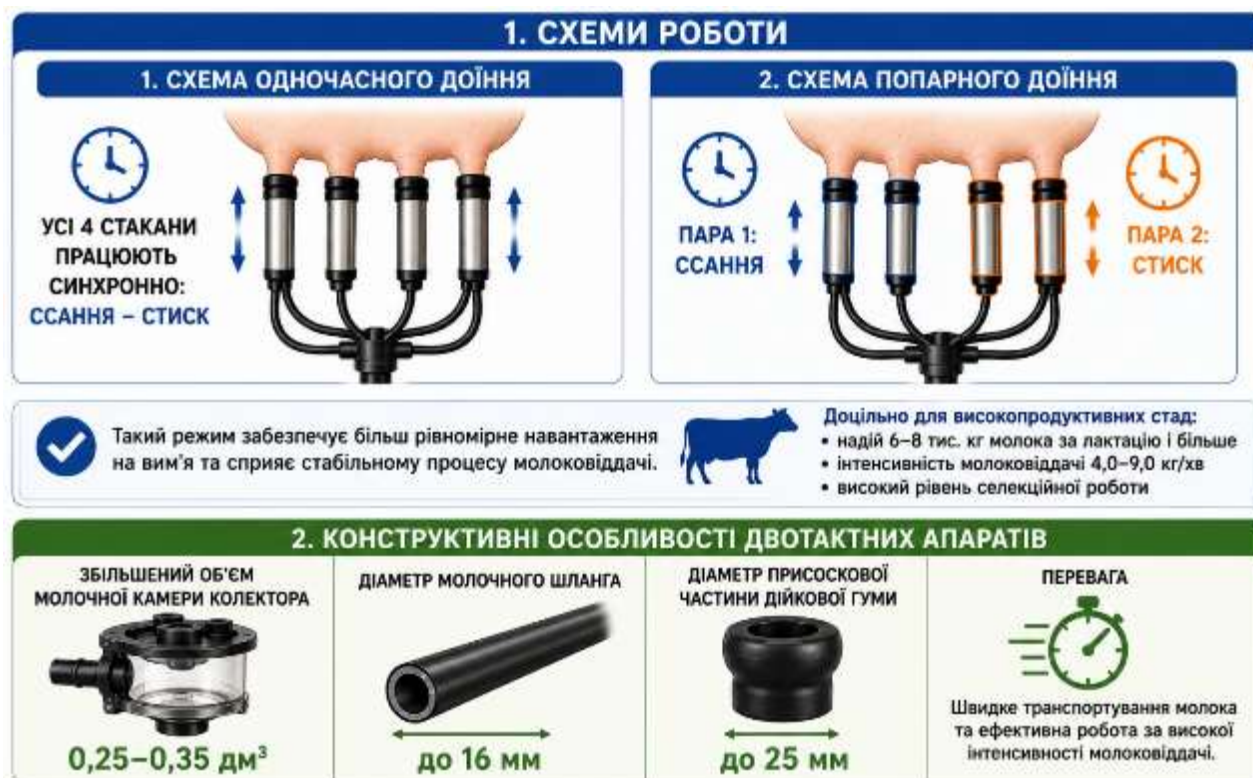
Рис. 7.18. Схеми роботи та конструктивні особливості двотактних доїльних апаратів
