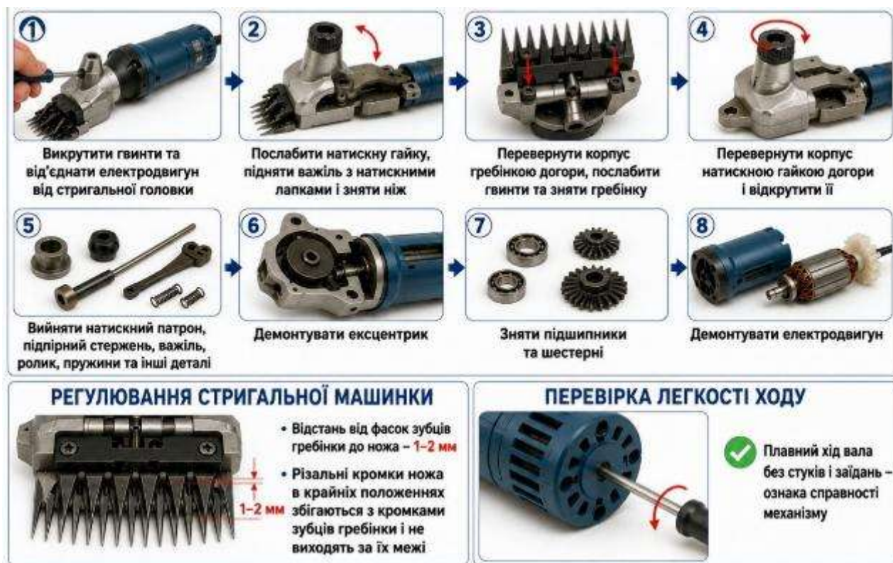
Рис. 8.17. Послідовність розбирання стригальної машинки MCSU-200A (MCSU-200)
