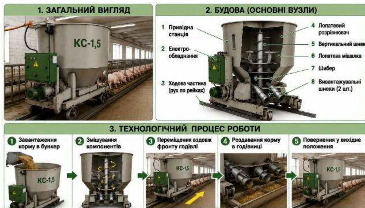
Рис. 5.18. Загальний вигляд, будова та технологічний процес роботи кормороздавача-змішувача КС-1,5
