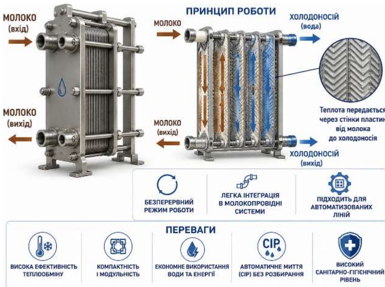
Рис. 7.34. Будова, принцип роботи та основні переваги пластинчастого охолоджувача молока
