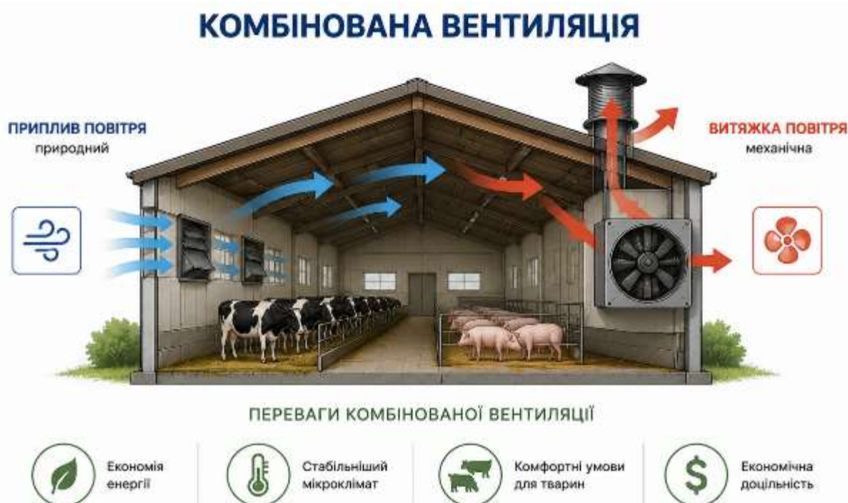
Рис. 2.16. Схема роботи комбінованої вентиляції тваринницьких приміщень
