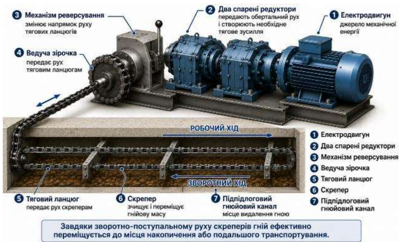
Рис. 6.10. Привід і принцип роботи скреперної установки для видалення гною з підпідлогового каналу
