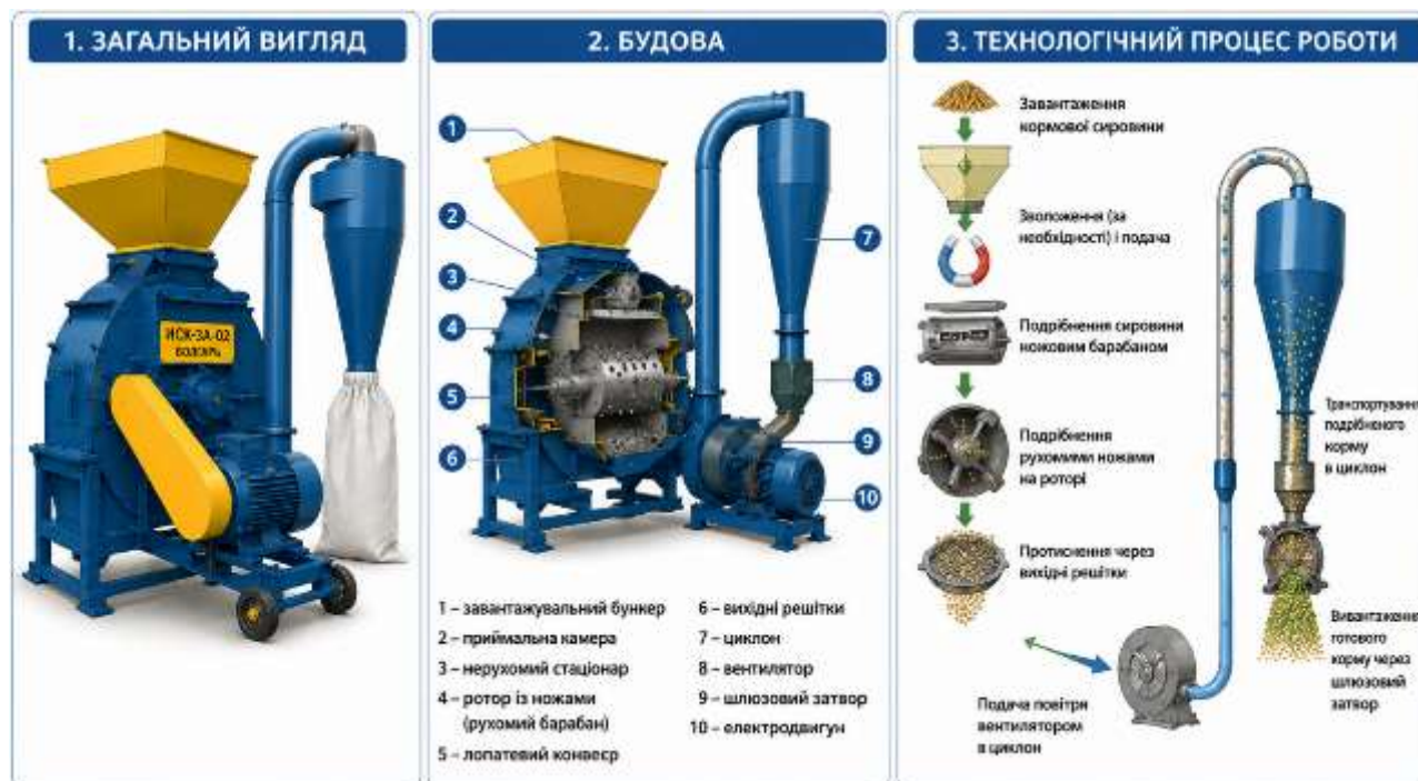
Рис. 4.17. Загальний вигляд, будову та технологічний процес роботи кормодробарки «Українка» КДУ-2М
