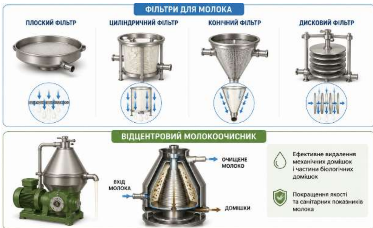
Рис. 7.30. Засоби для очищення молока: фільтри різних типів та відцентровий молокоочисник
