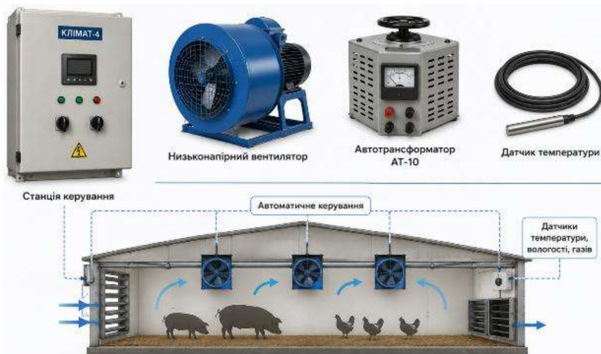
Рис. 2.35. Зовнішній вигляд, основні складові та принцип роботи комплексу «Клімат-4»
