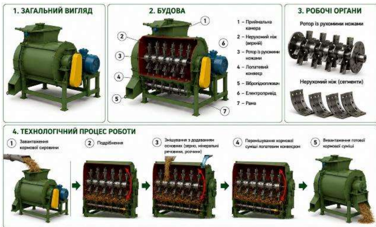
Рис. 4.13. Подрібнювач-змішувач кормів ИСК-3А: загальний вигляд, будова та технологічний процес роботи
