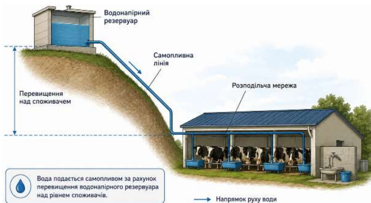
Рис. 3.1. Будова та принцип роботи самопливної системи водопостачання
