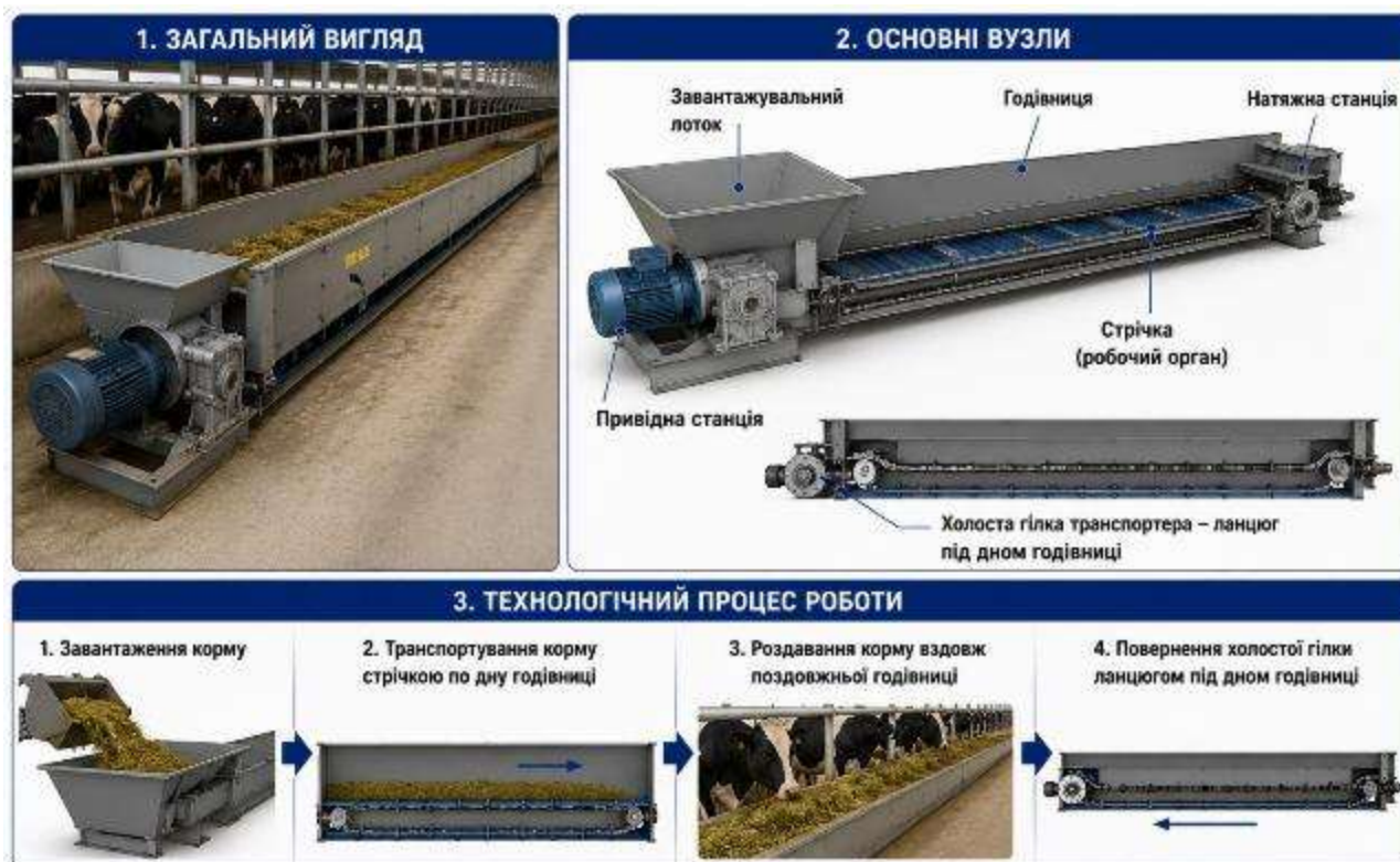
Рис. 5.16. Загальний вигляд, будова та технологічний процес роботи кормороздавача ТВК-80Б
