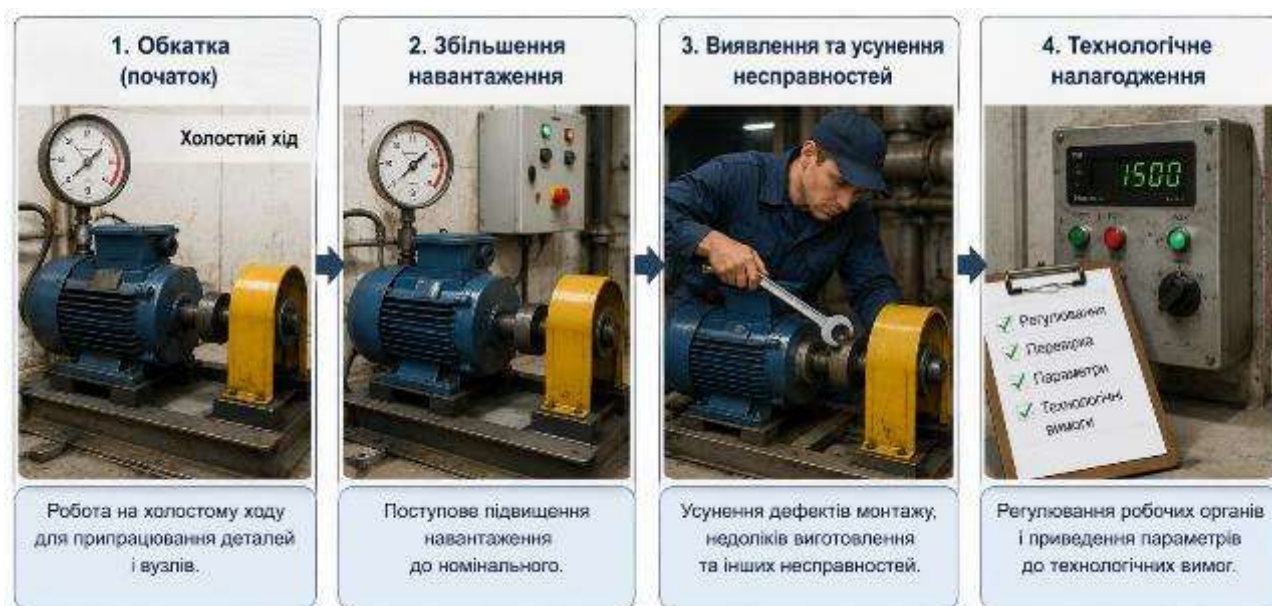
Рис. 10.10. Основні етапи обкатки та технологічного налагодження машин у виробничих умовах
