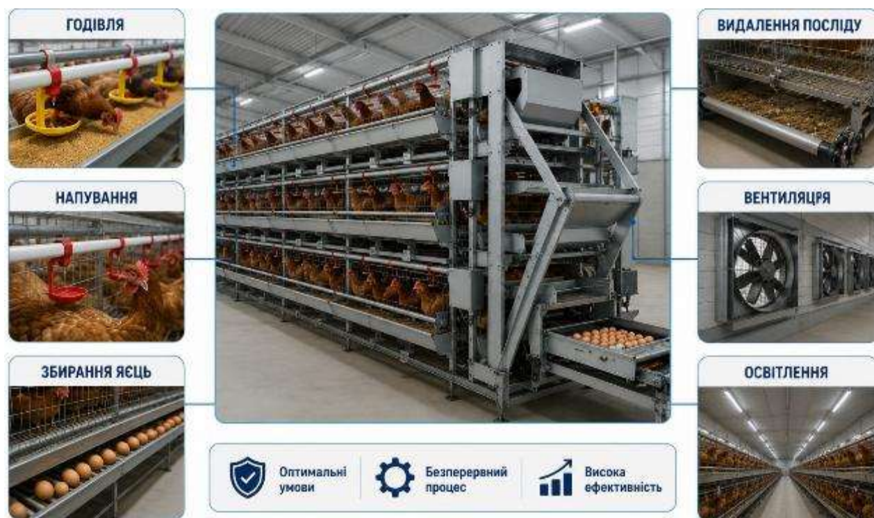
Рис. 9.34. Комплект обладнання кліткових батарей для комплексної механізації технологічних процесів у птахівництві
