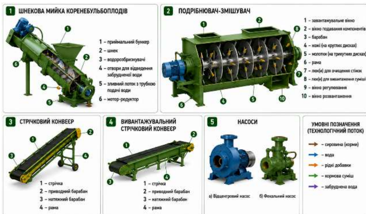
Рис. 4.19. Будова основних вузлів агрегату для приготування кормових сумішей АПК-10А
