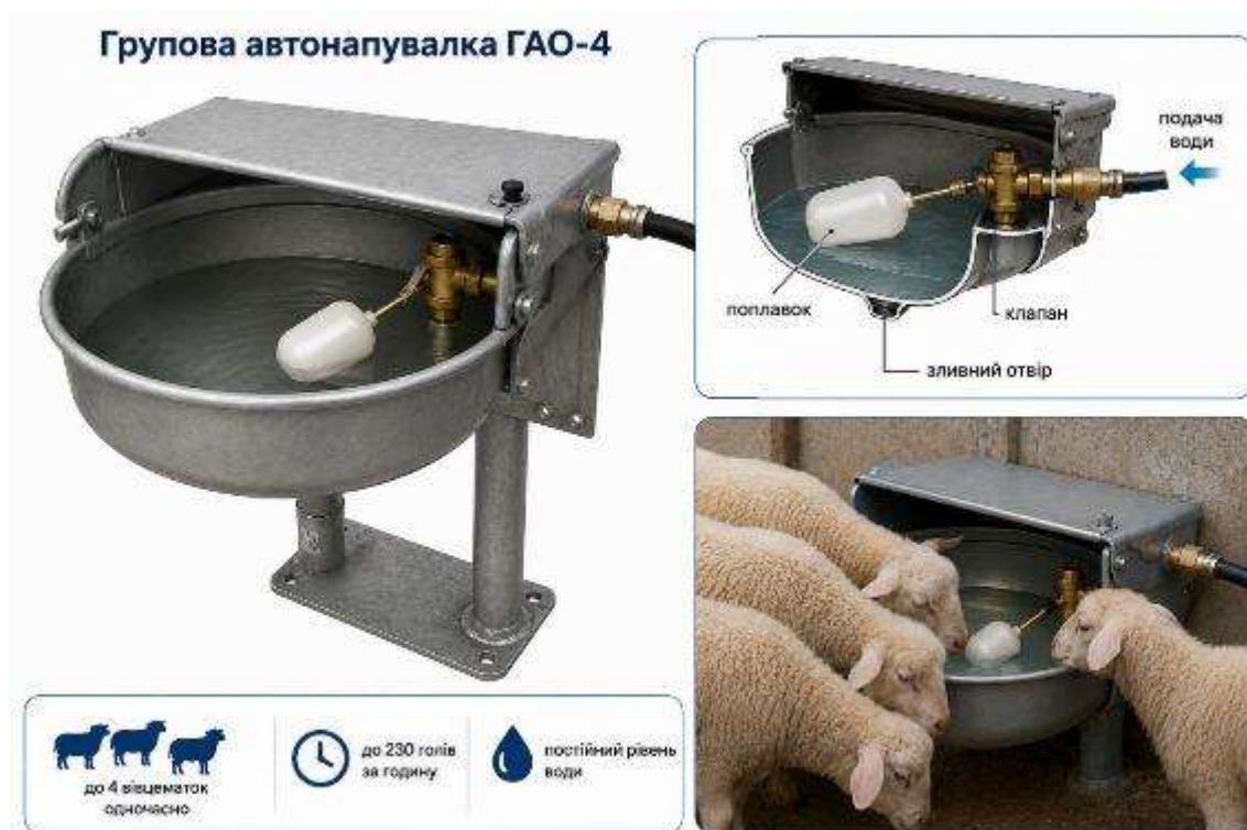
Рис. 3.22. Групова автонапувалка ГАО-4: загальний вигляд, будова та принцип роботи
