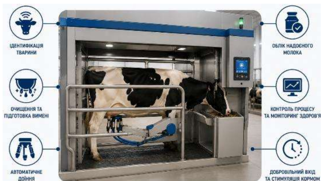
Рис. 7.27. Роботизована доїльна установка та її основні функціональні можливості
