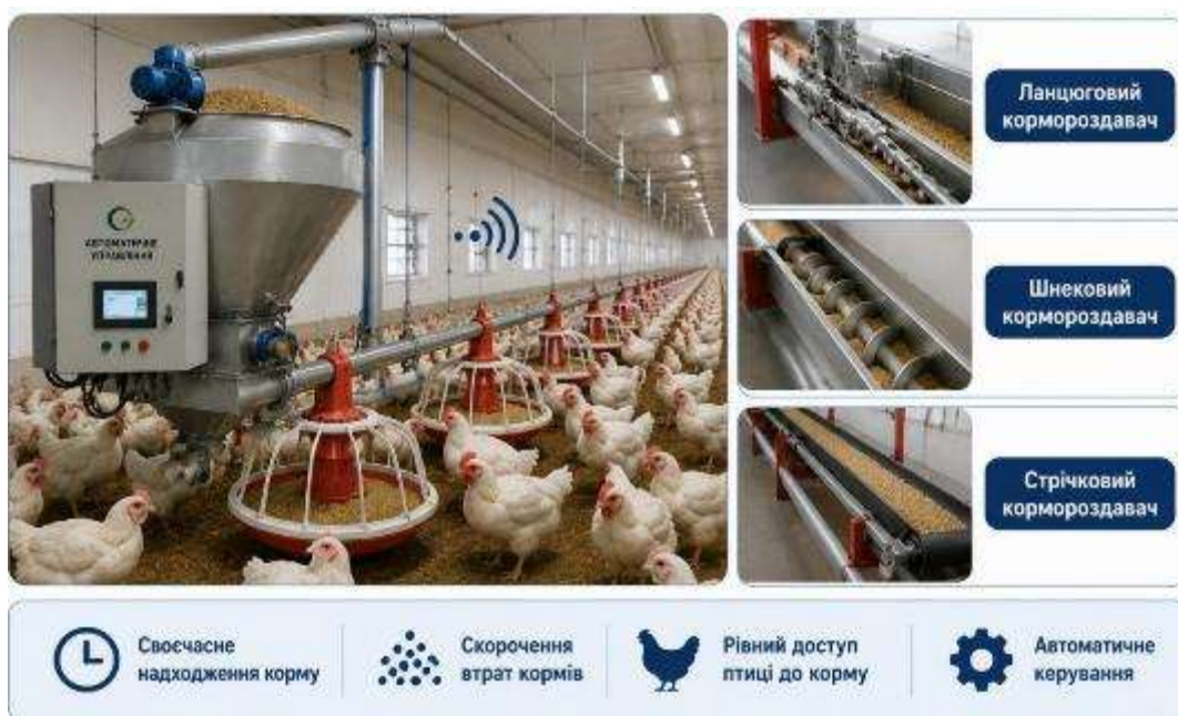
Рис. 9.29. Система автоматизованого роздавання кормів у пташниках
