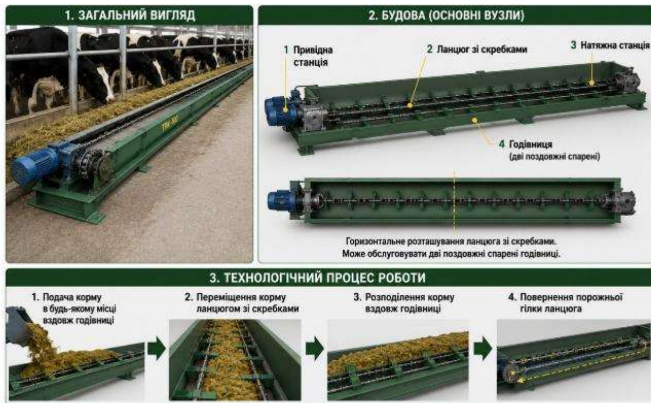
Рис. 5.17. Загальний вигляд, будова та технологічний процес роботи роздавача ТРК-100
