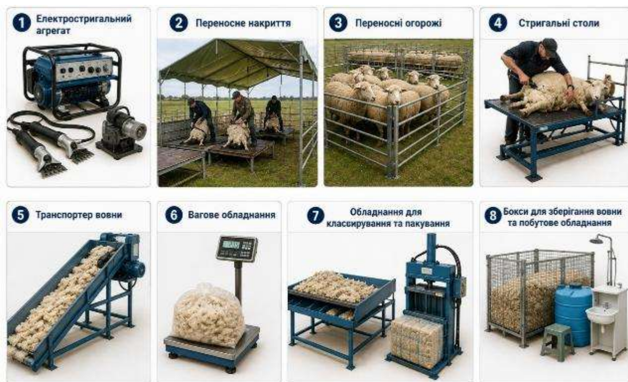
Рис. 8.14. Основне обладнання потокової технологічної лінії стрижки овець
