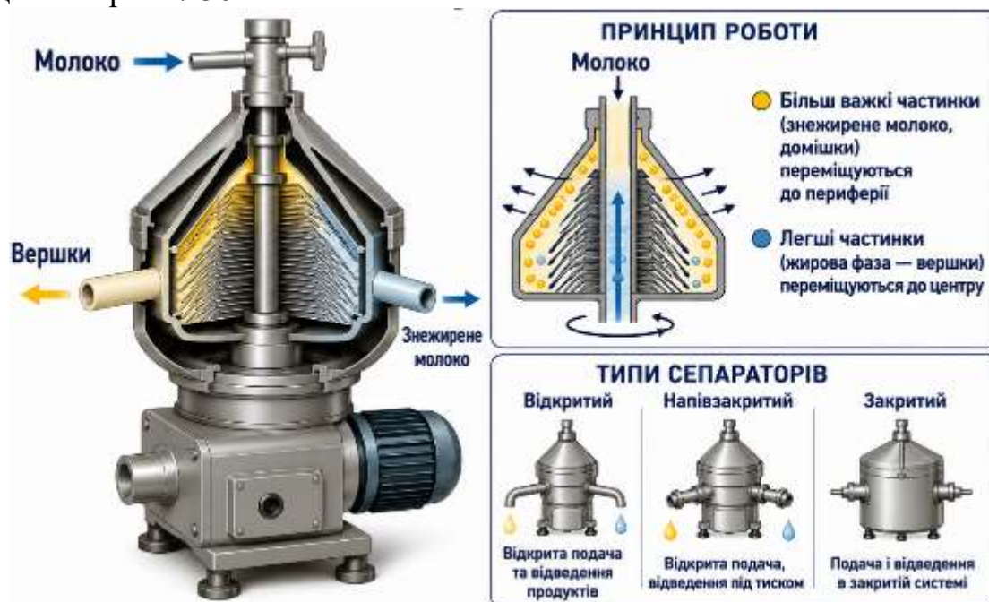
Рис. 7.36. Будова сепаратора, принцип сепарації молока та основні типи сепараторів
