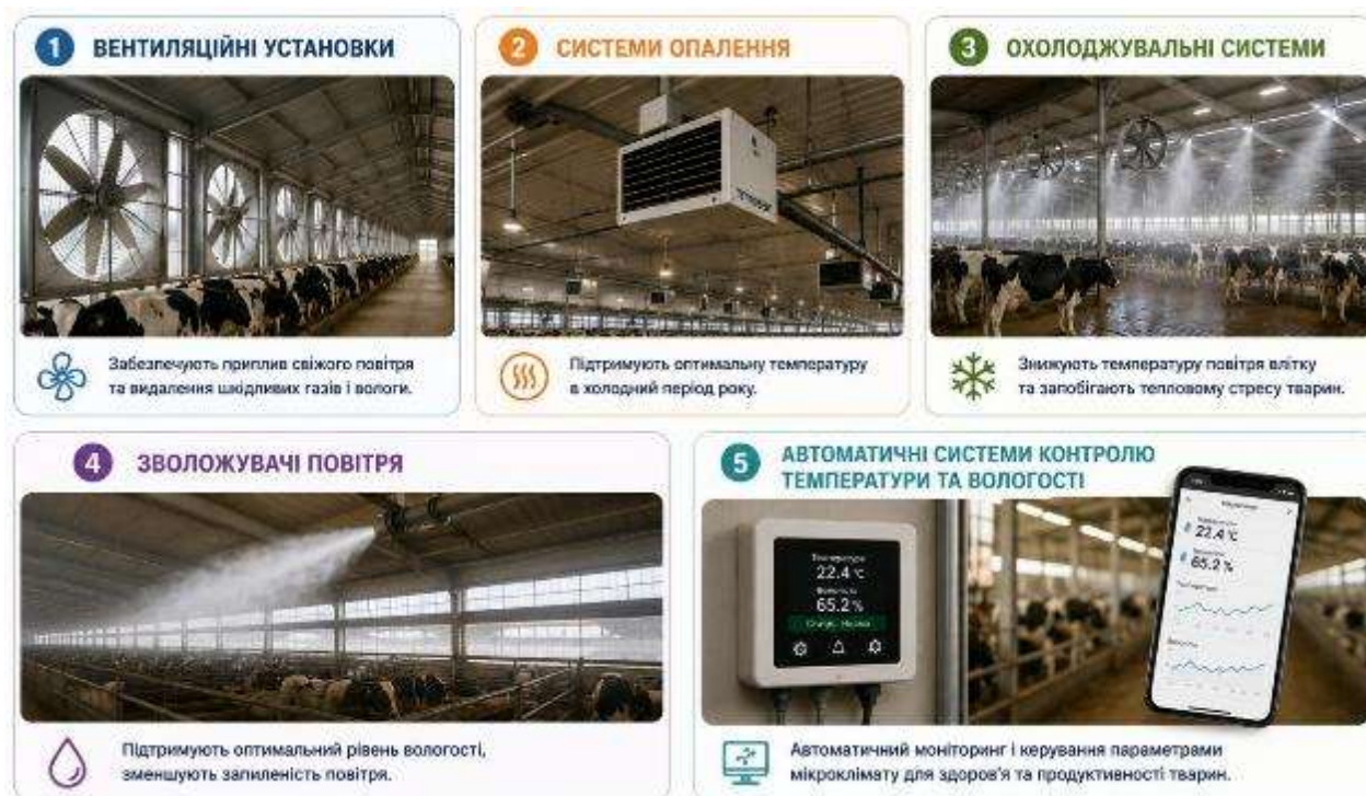
Рис. 1.20. Основні види обладнання для підтримання оптимального мікроклімату в тваринницьких приміщеннях
