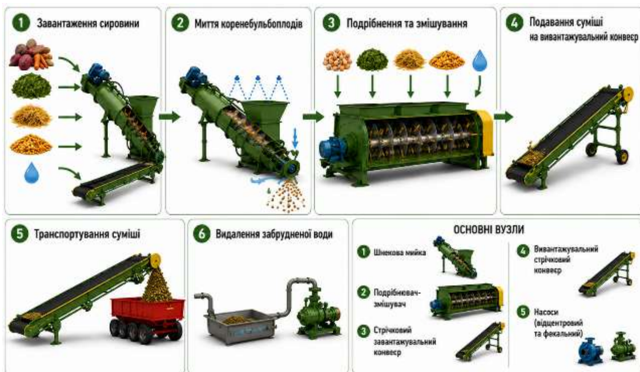
Рис. 4.20. Технологічний процес роботи агрегату для приготування кормових сумішей АПК-10А
