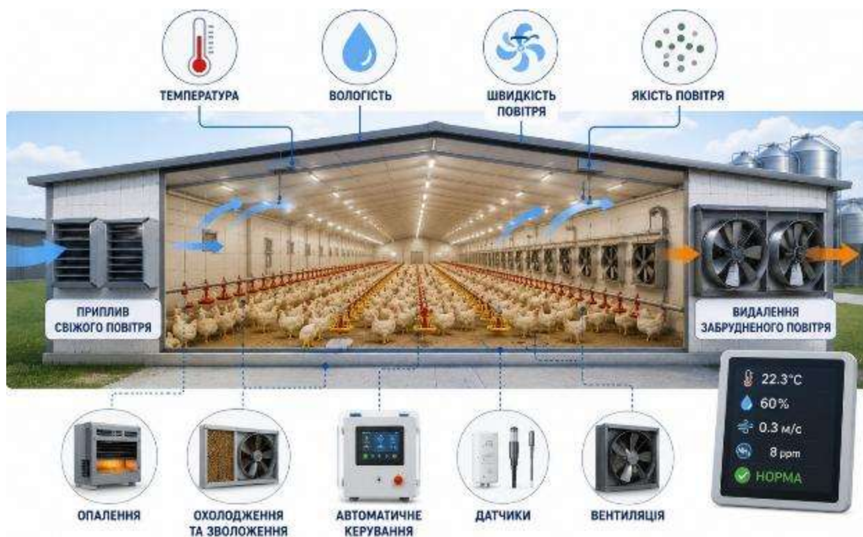
Рис. 9.32. Система механізованого підтримання оптимального мікроклімату в пташниках
