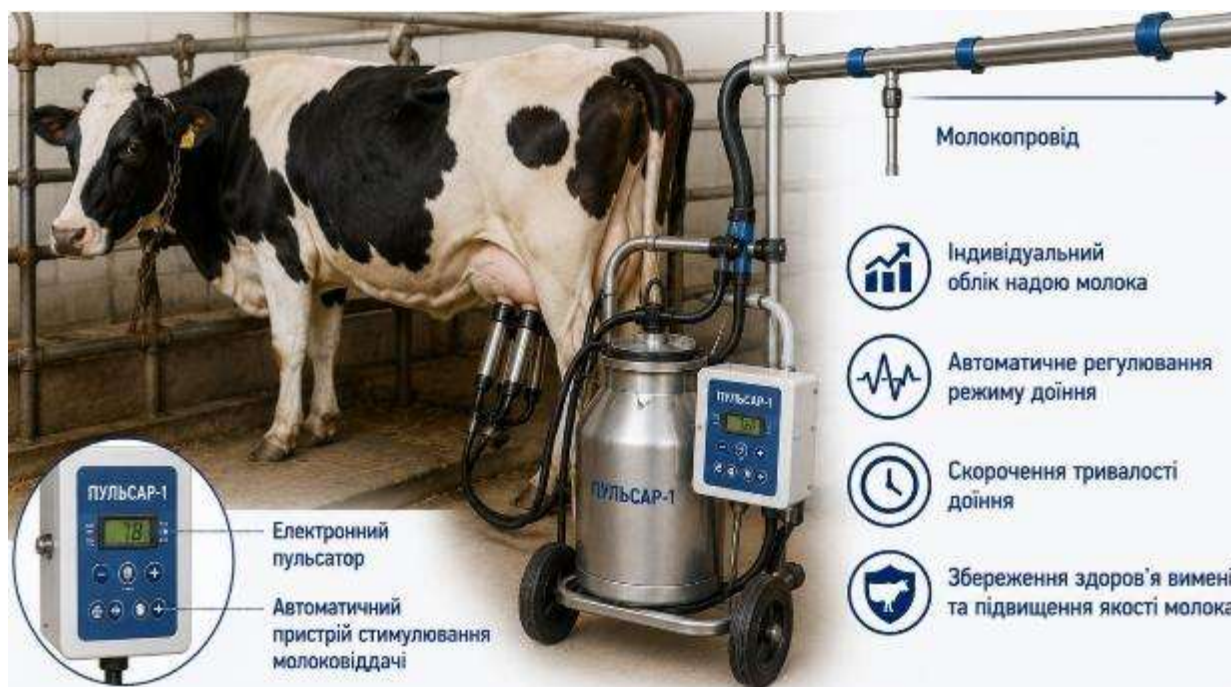
Рис. 7.25. Переносний доїльний апарат «Пульсар-1» для доїння в молокопровід за прив'язної системи утримання корів
