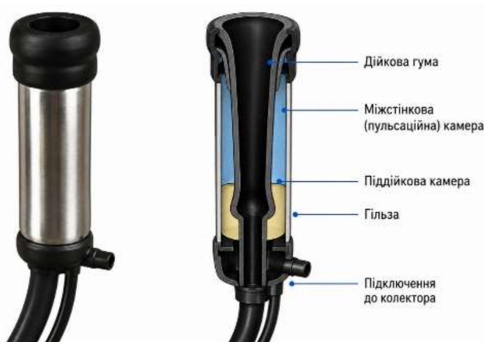
Рис. 7.16. Будова двокамерного доїльного стакана
