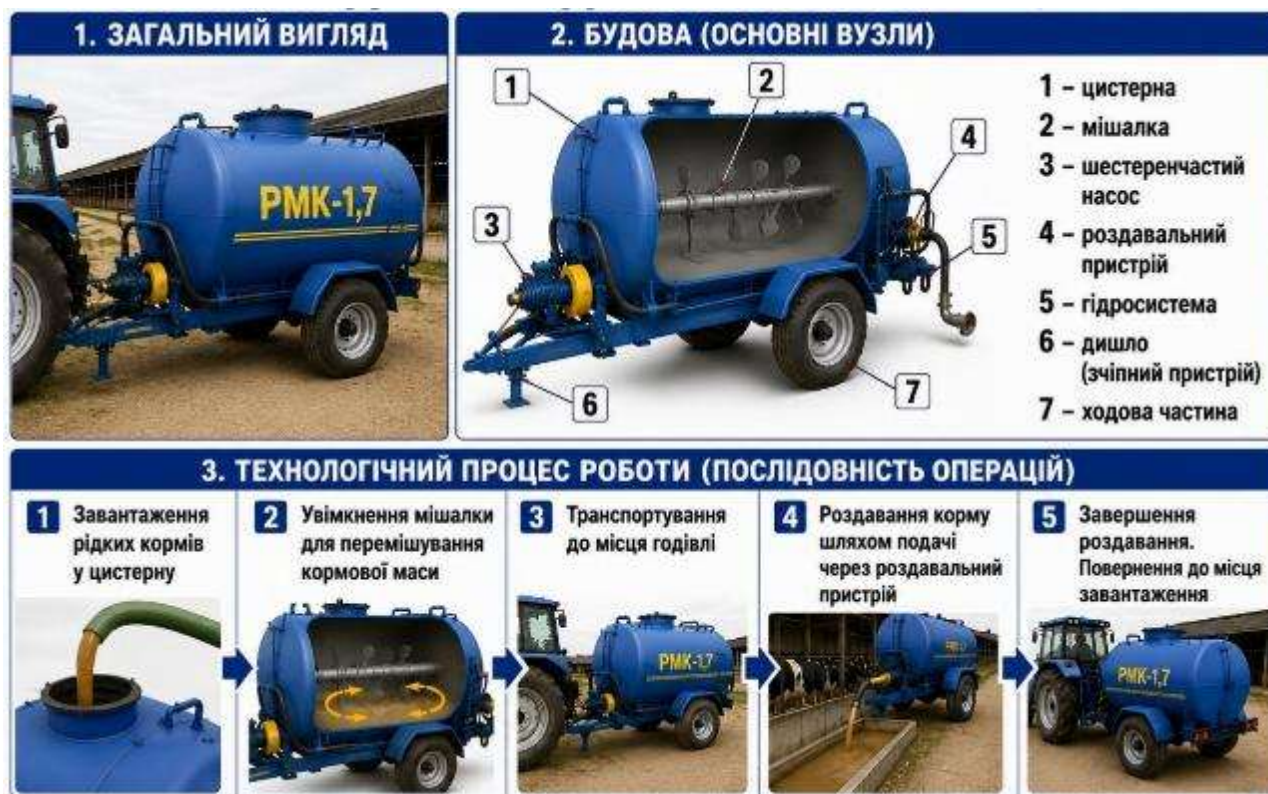
Рис. 5.14. Загальний вигляд, будову та технологічний процес роботи роздавача рідких кормів РМК-1,7
