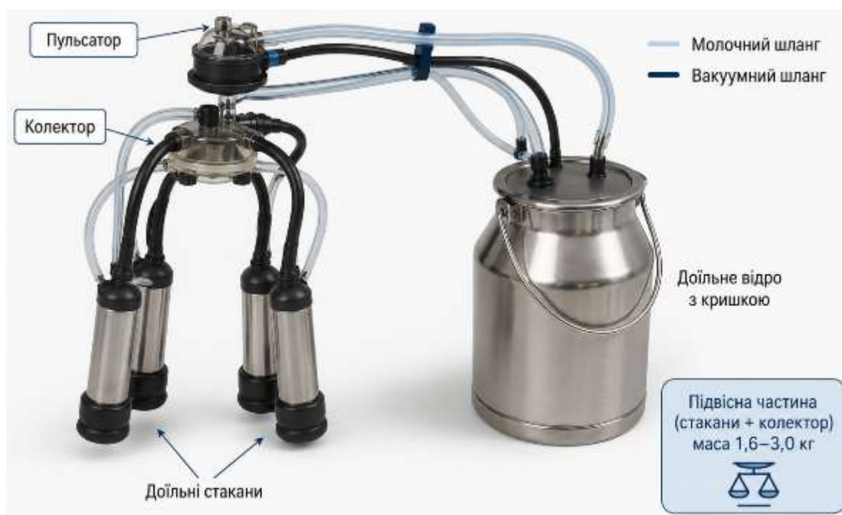
Рис. 7.15. Будова доїльного апарата вакуумного типу
