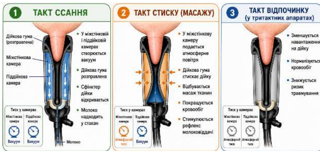
Рис. 7.17. Такти роботи двокамерного доїльного стакана
