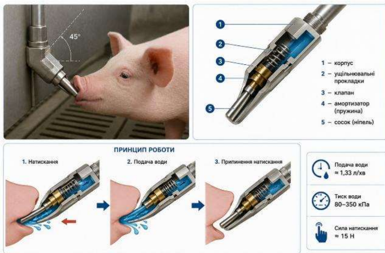
Рис. 3.19. Соскова (ніпельна) автонапувалка для свиней: загальний вигляд, будова та принцип роботи
