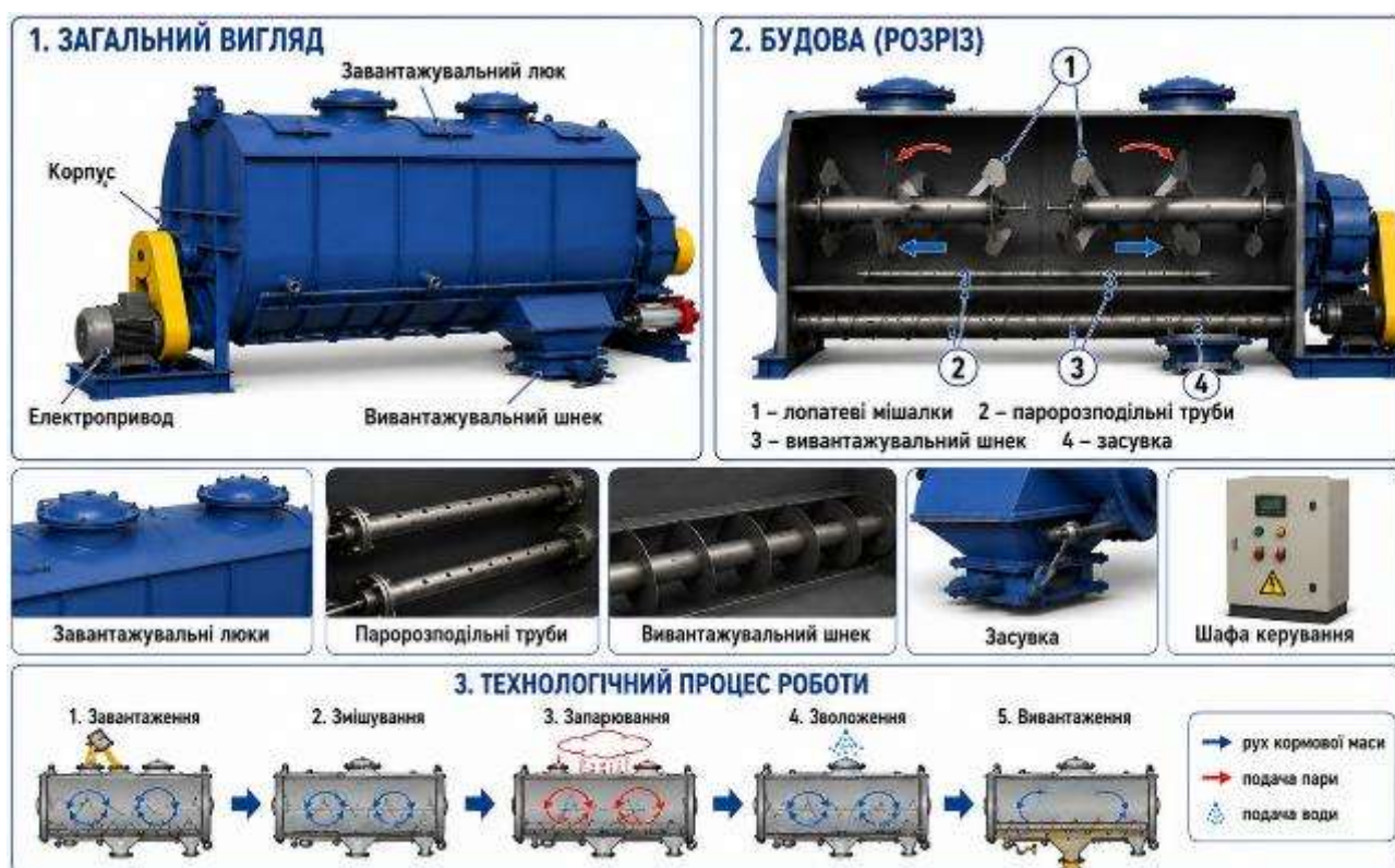
Рис. 4.25. Загальний вигляд, будова та технологічний процес роботи змішувача кормів С-12
