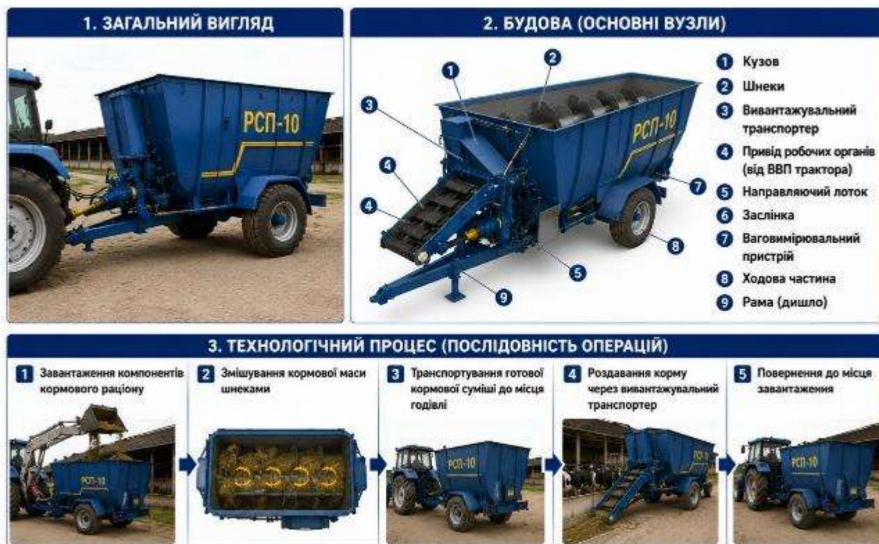
Рис. 5.15. Загальний вигляд, будова та технологічний процес роботи роздавача-змішувача РСП-10
