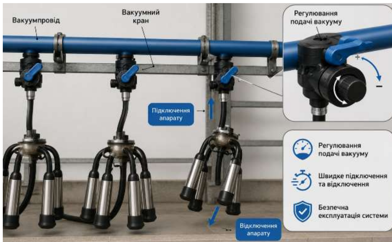
Рис. 7.14. Схема підключення доїльного апарата до вакуумпроводу за допомогою вакуумного крана
