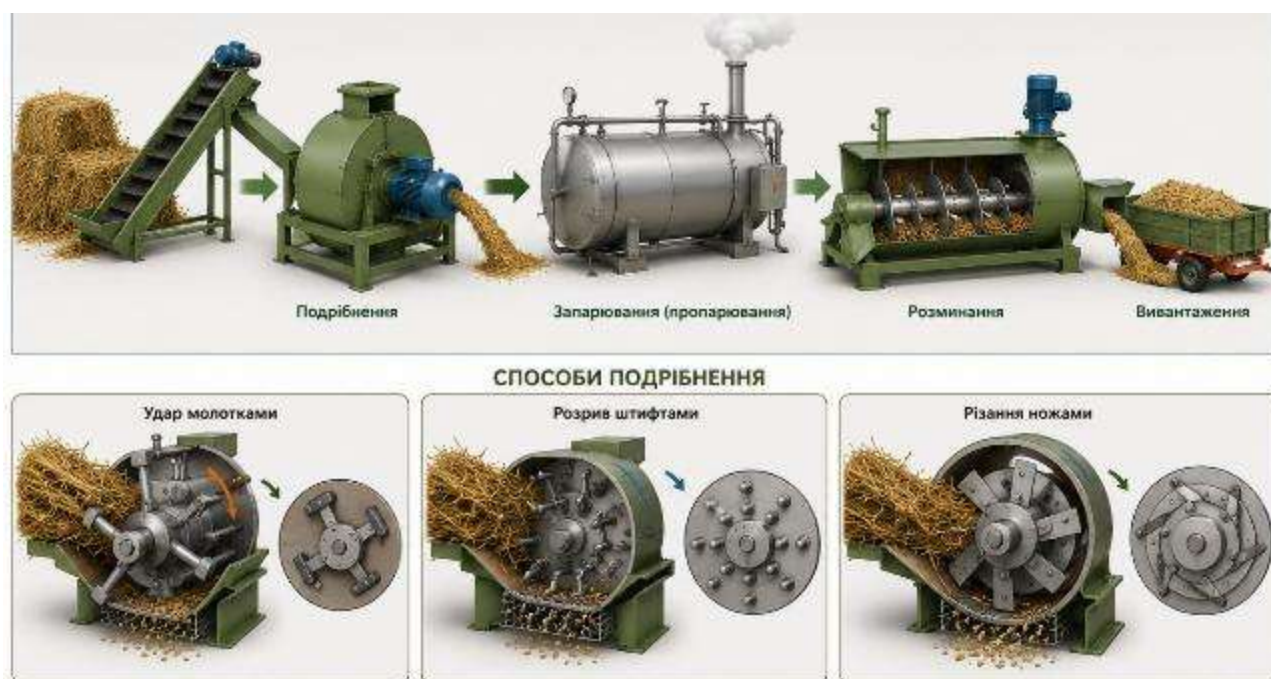
Рис. 4.10. Способи подрібнення грубих кормів та принцип дії робочих органів подрібнювачів
