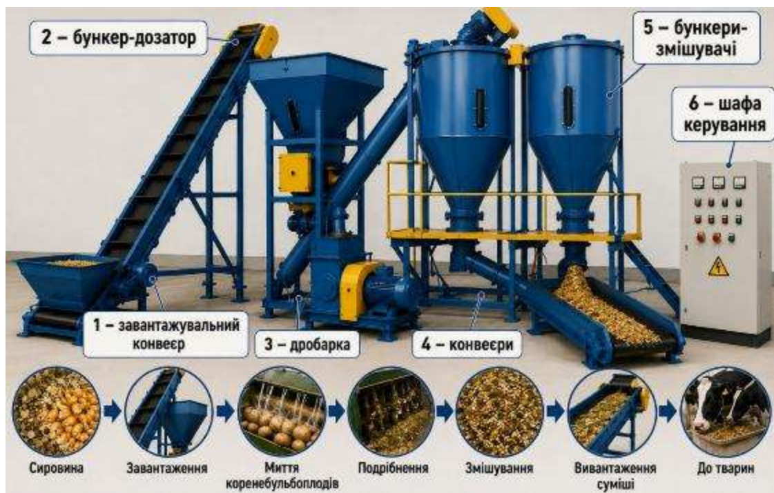
Рис. 4.21. Загальний вигляд, основні вузли та технологічний процес роботи агрегату ОВК-2
