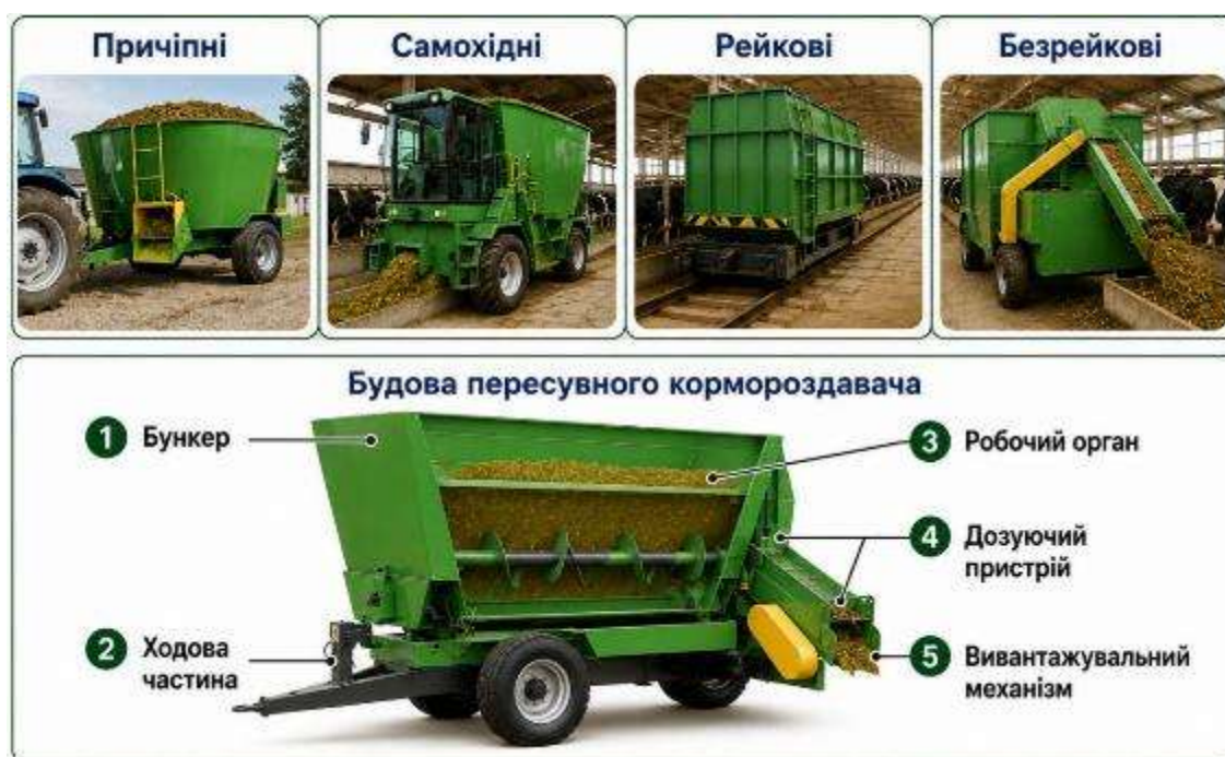
Рис. 5.8. Класифікація пересувних кормороздавачів за способом пересування та будова причіпного кормороздавача
