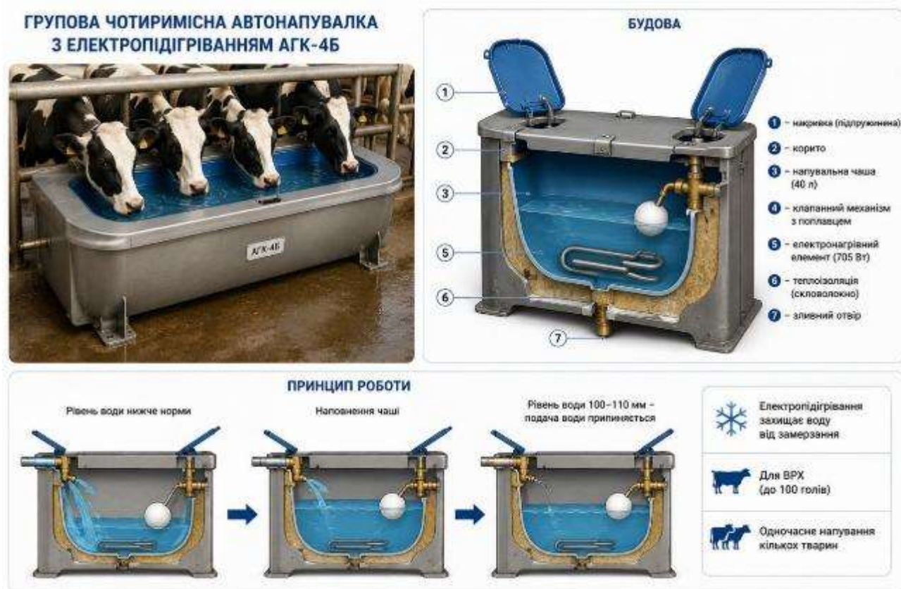
Рис. 3.17. Групові чотиримісні автонапувалки з електропідігріванням АГК-4Б: загальний вигляд, будова та принцип роботи
