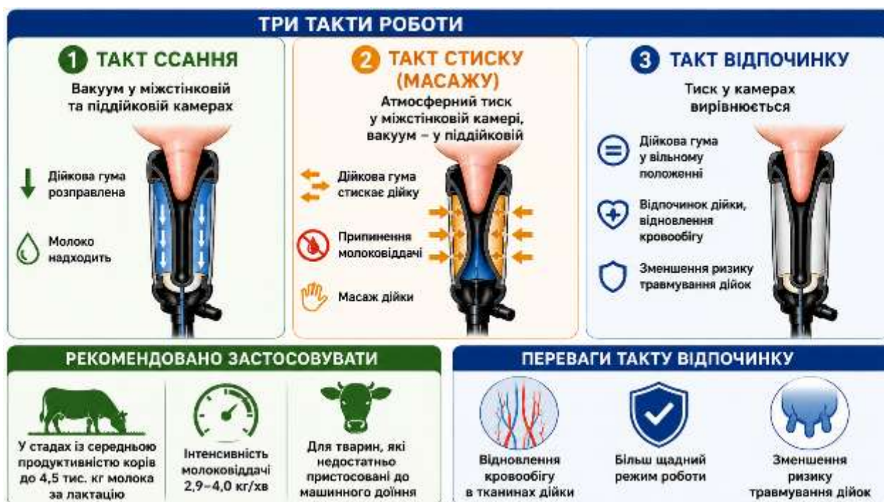
Рис. 7.19. Особливості роботи тритактних доїльних апаратів
