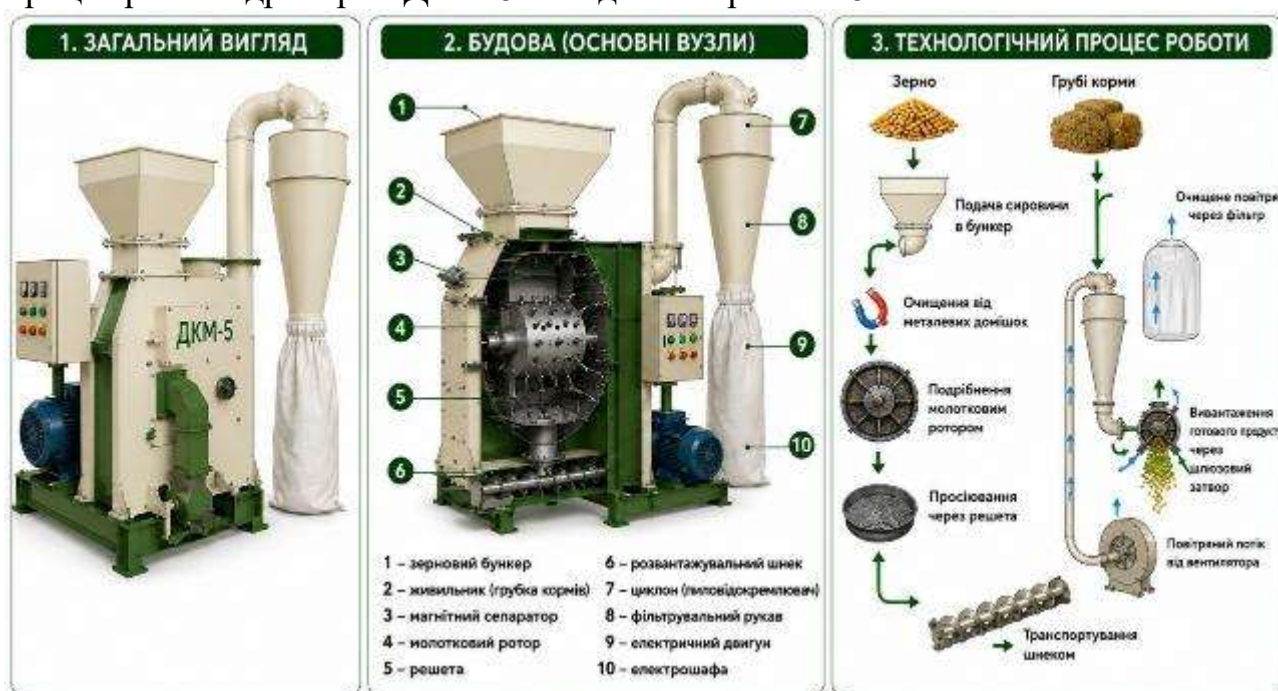
Рис. 4.18. Загальний вигляд, будову та технологічний процес роботи дробарки ДКМ-5
