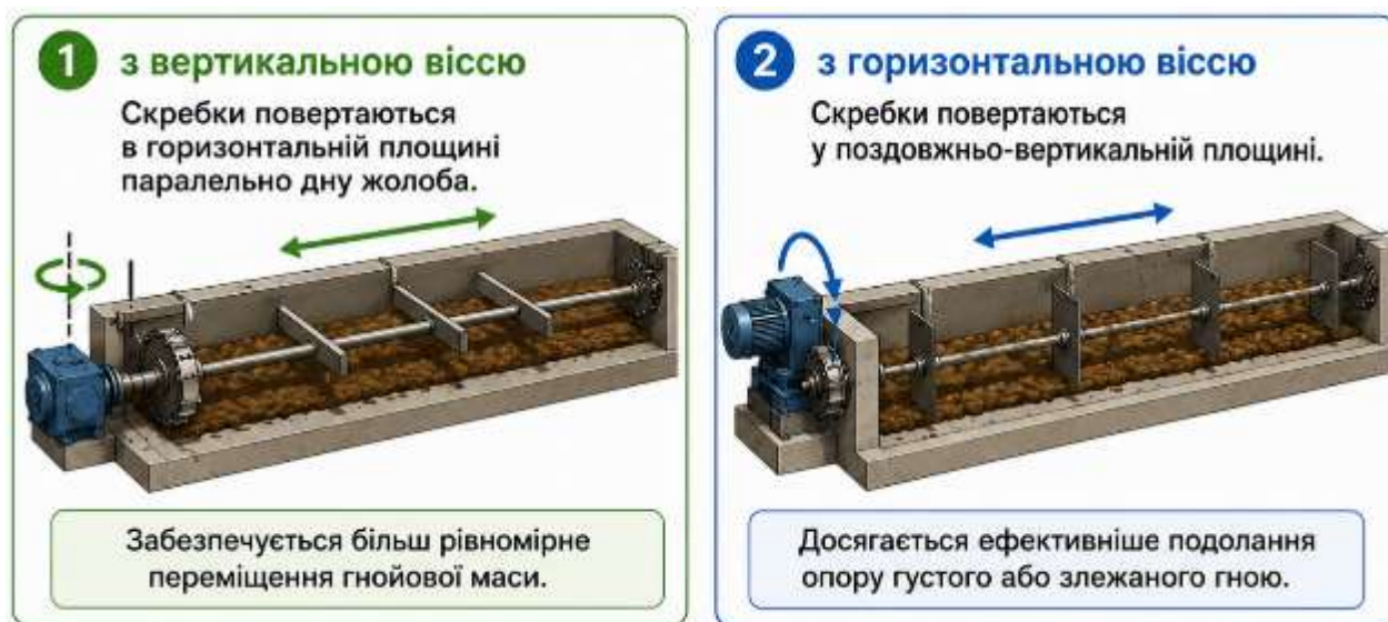
Рис. 6.9. Типи скребкових транспортерів зі зворотно-поступальним рухом залежно від розташування осі підвіски скребків
