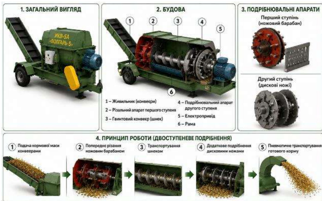
Рис. 4.12. Подрібнювач кормів ИКВ-5А «Волгарь-5»: загальний вигляд, будова та принцип роботи
