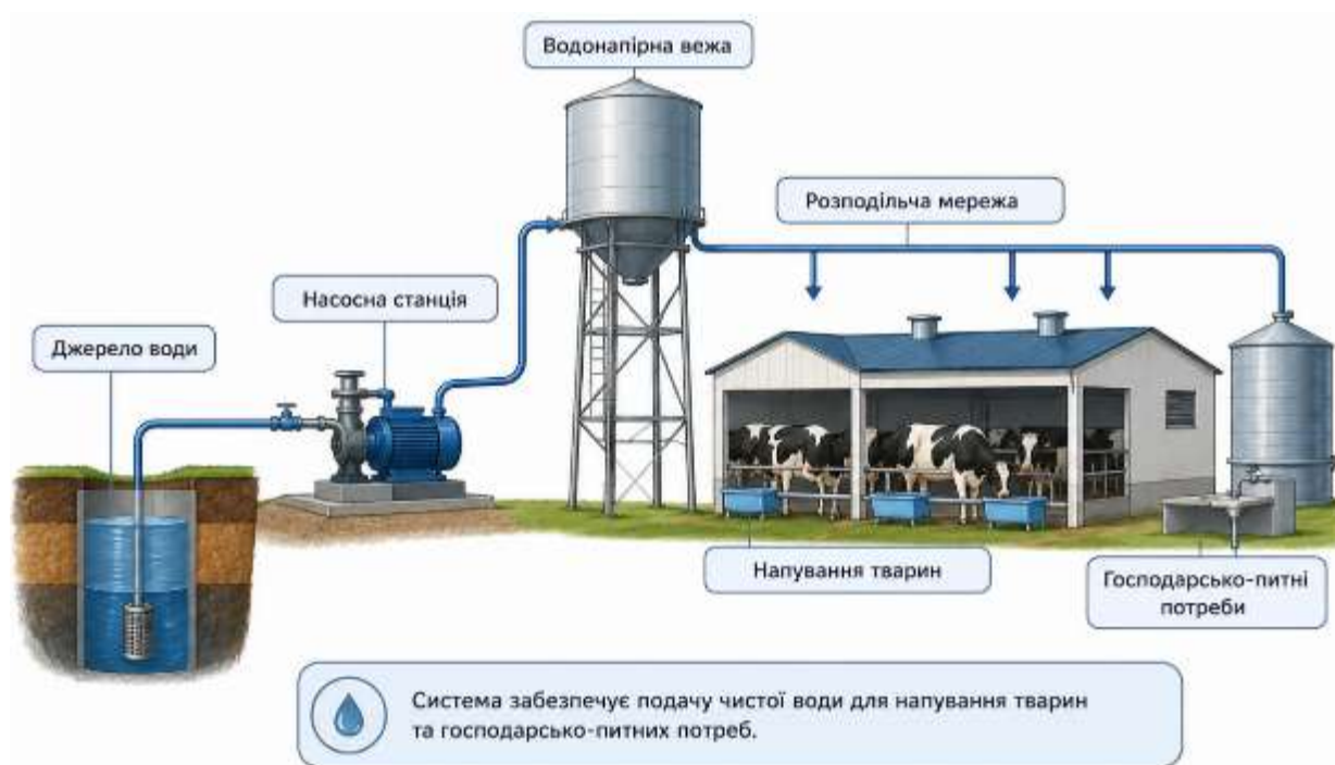
Рис. 3.2. Будова та принцип роботи напірної системи водопостачання тваринницького підприємства
