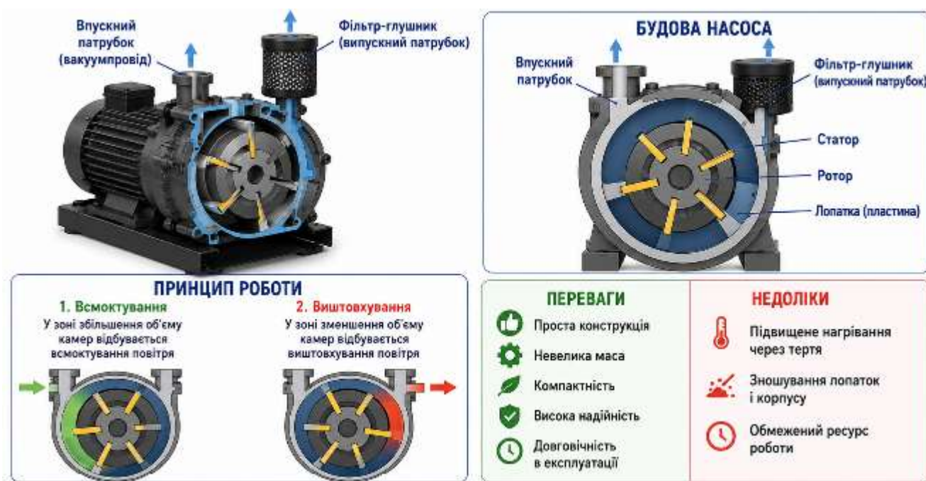
Рис. 7.10. Будова та принцип роботи ротаційного пластинчастого (лопатевого) вакуумного насоса
