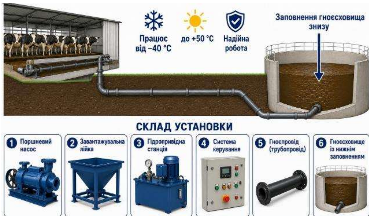
Рис. 6.17. Будова та принцип роботи установки УТН-10
