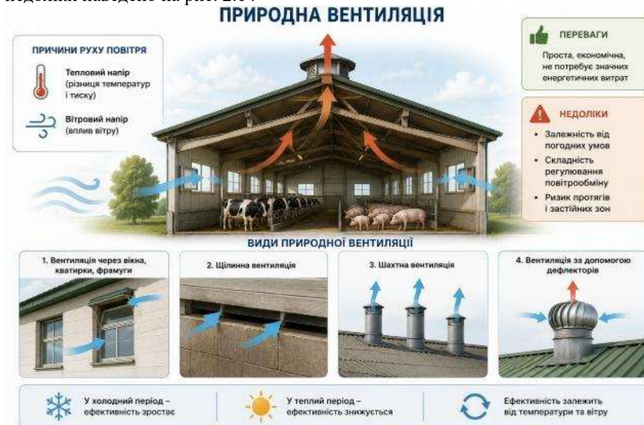
Рис. 2.14. Схема роботи природної вентиляції тваринницьких приміщень
