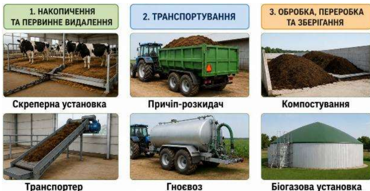
Рис. 6.1. Загальна схема технологічного процесу та основних технічних засобів
