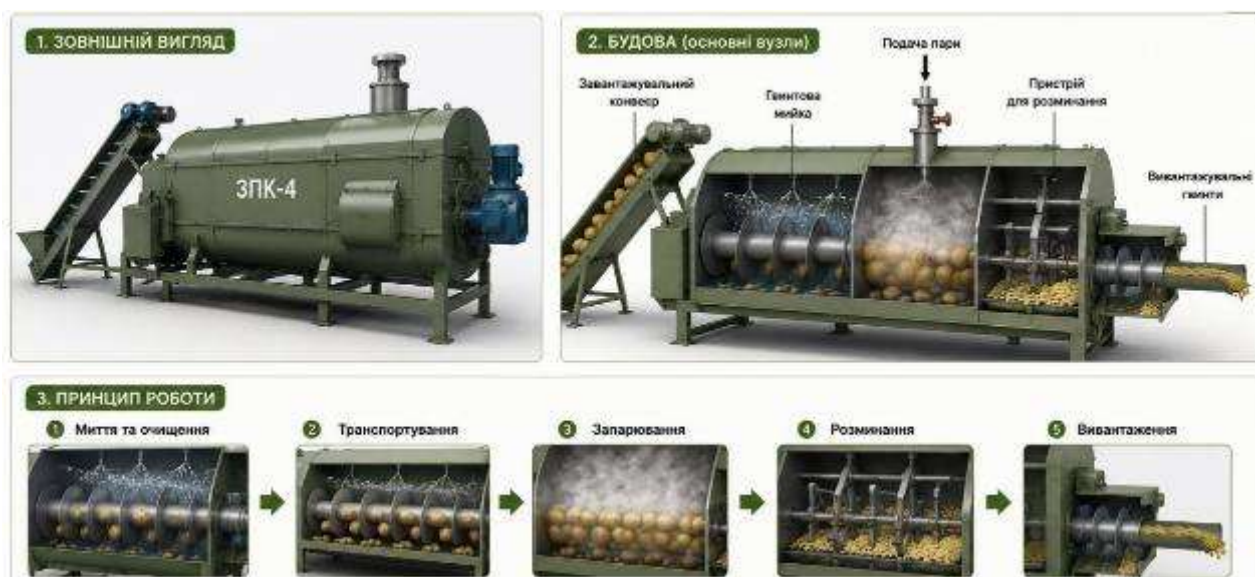
Рис. 4.8. Агрегат ЗПК-4: загальний вигляд, будова та принцип роботи
