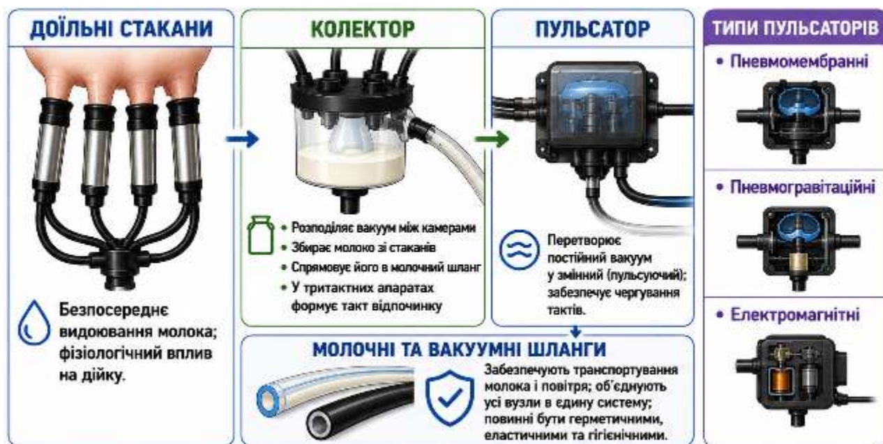
Рис. 7.20. Основні елементи доїльного апарата та їх функціональне призначення
