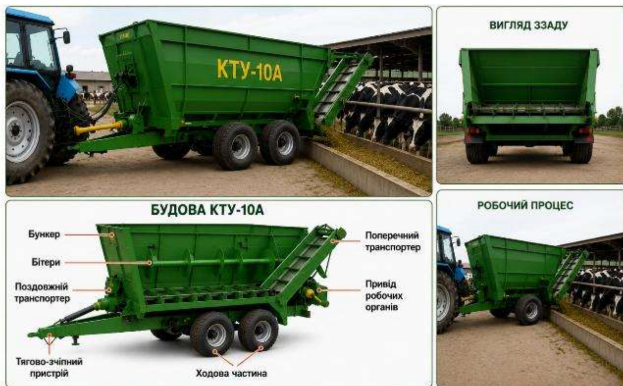
Рис. 5.9. Загальний вигляд, основні вузли та процес роботи кормороздавача тракторного універсального КТУ-10А
