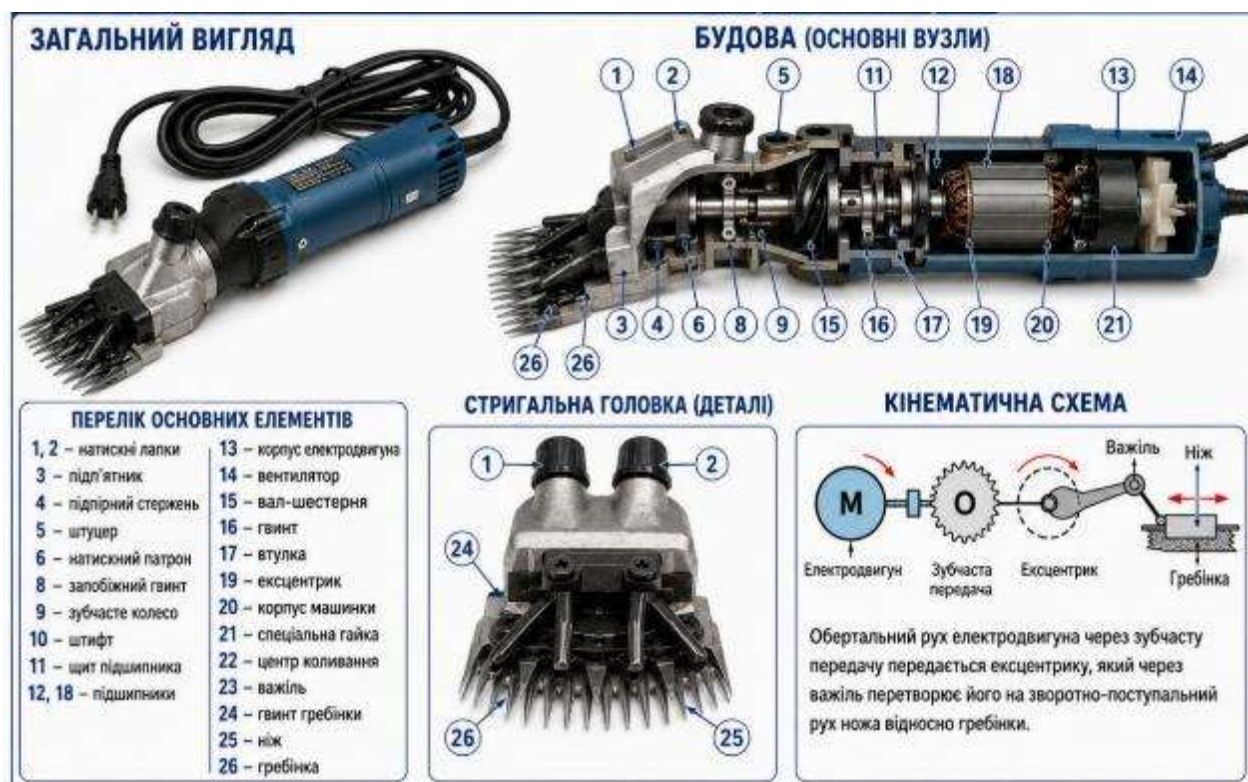
Рис. 8.16. Загальний вигляд, будова основних вузлів і кінематична схема стригальної машинки MCSU-200A (MCSU-200)
