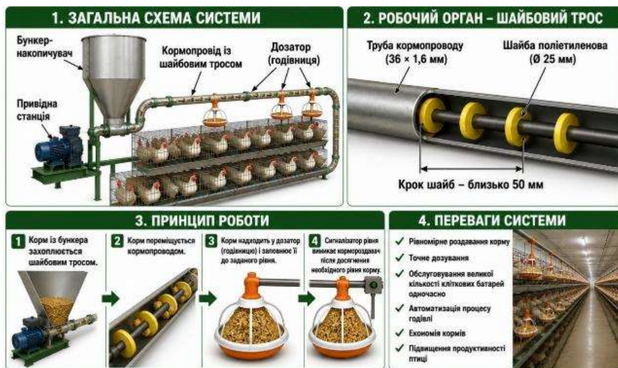
Рис. 5.19. Загальна схема, будова та принцип роботи ланцюгово-шайбового кормороздавача
