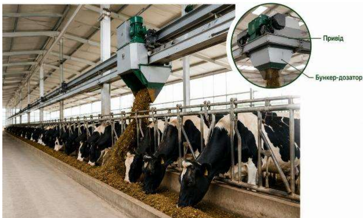
Рис. 5.6. Загальний вигляд і принцип роботи надгодівничного кормороздавача
