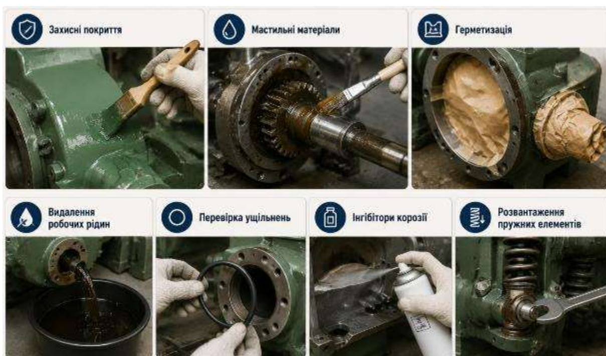
Рис. 5.20. Основні заходи консервації машин і обладнання перед тривалим зберіганням
