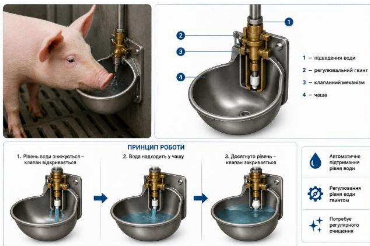
Рис. 3.20. Чашкова автонапувалка для свиней: загальний вигляд, будова та принцип роботи
