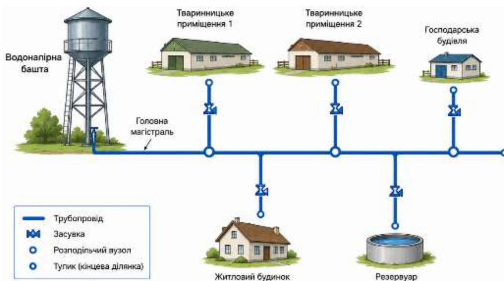
Рис. 3.10. Схема тупикової водопровідної мережі
