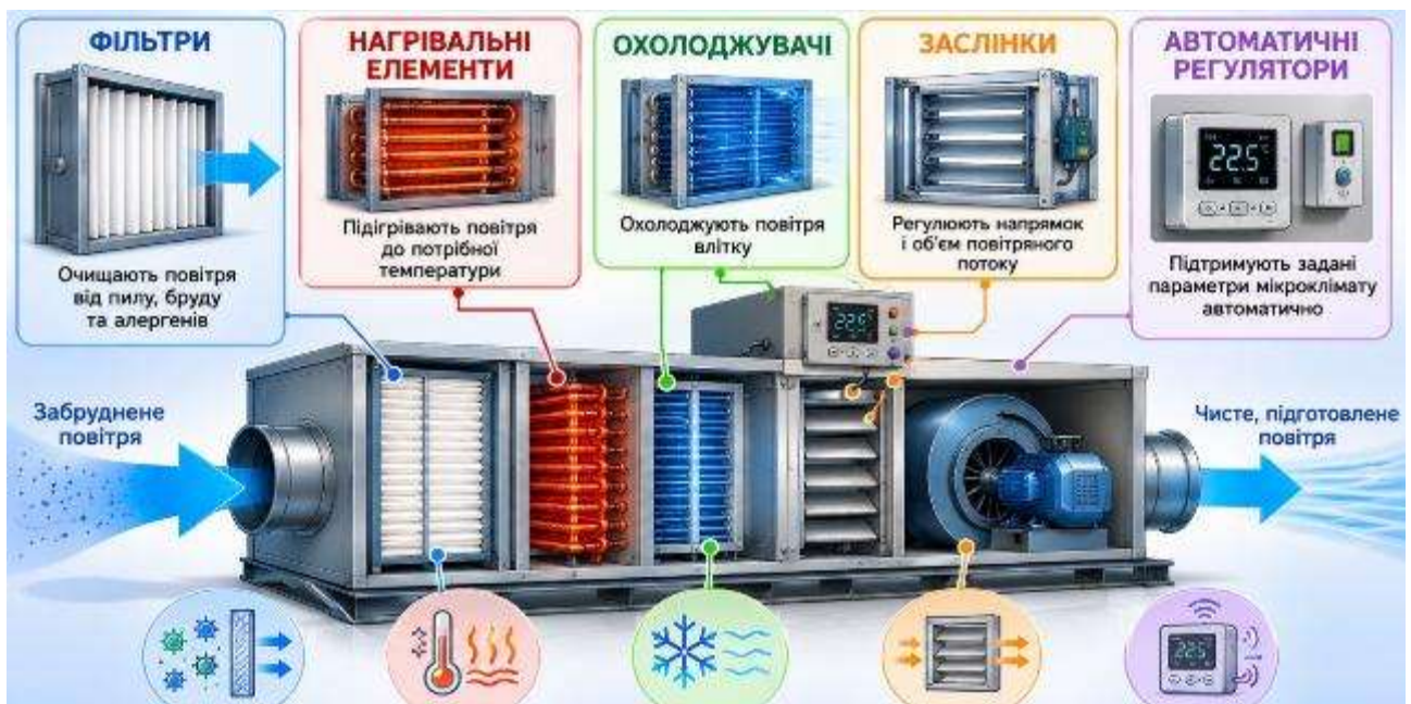
Рис. 2.27. Основні елементи вентиляційної установки: фільтри, нагрівальні елементи, охолоджувачі, заслінки та автоматичні регулятори
