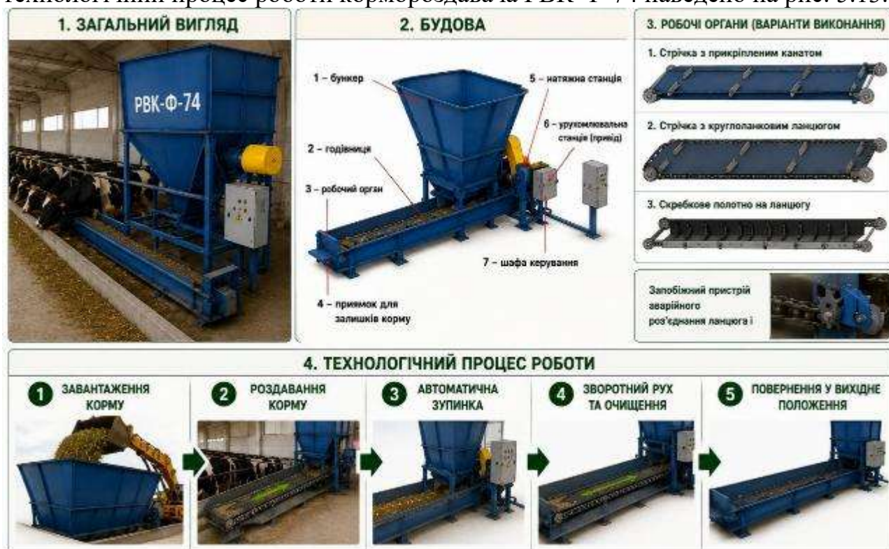
Рис. 5.13. Загальний вигляд, будова, варіанти виконання робочих органів і технологічний процес роботи кормороздавача РВК-Ф-74
