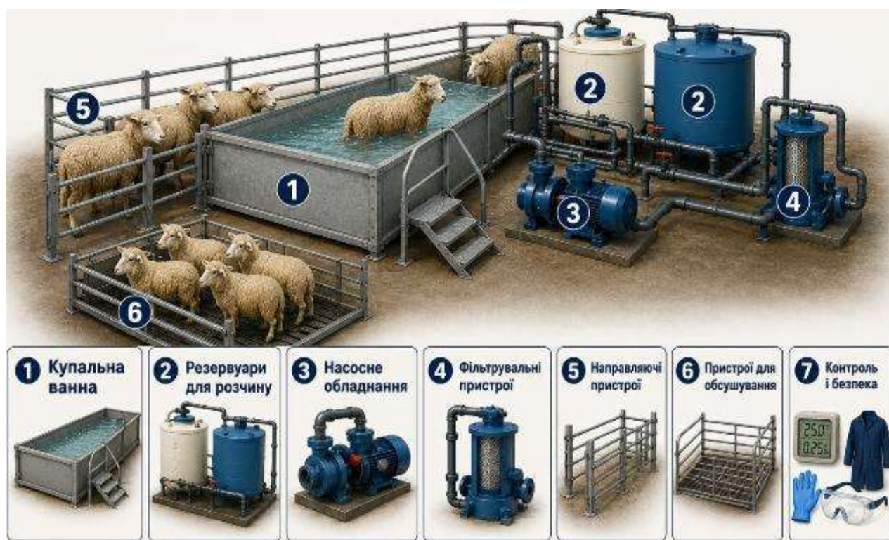
Рис. 8.10. Основні елементи обладнання для механізованого купання овець
