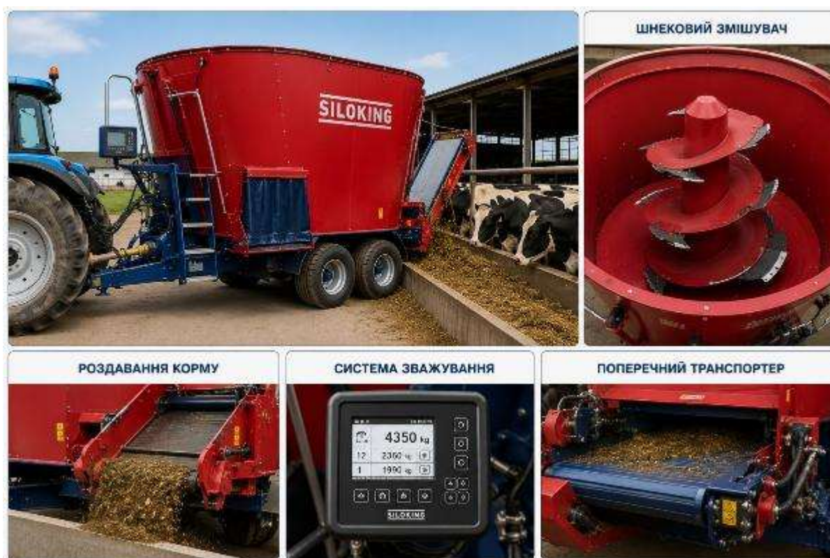
Рис. 5.10. Загальний вигляд, основні вузли та процес роботи комбінованого змішувача-роздавача кормових сумішей
