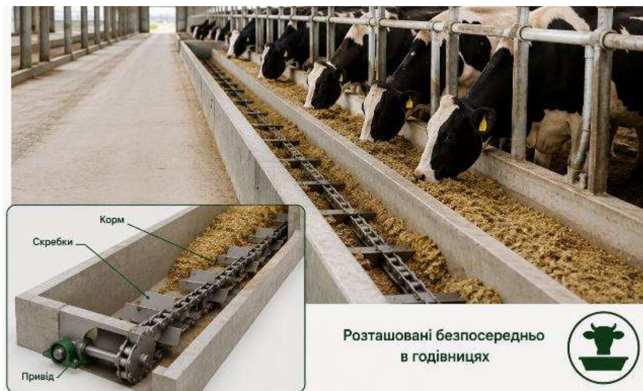
Рис. 5.5. Загальний вигляд і будова внутрішньогодівничного кормороздавача
