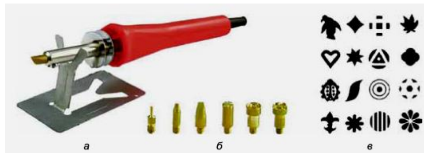
Мал. 2.9. Стрижневий випалювач: а – загальний вигляд; б – стрижневі штампи; в – елементи випалених орнаментів
