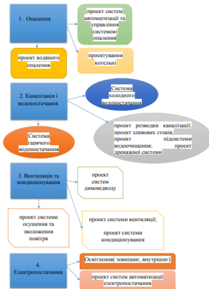
Рисунок 4. Інженерні системи житлового будинку
